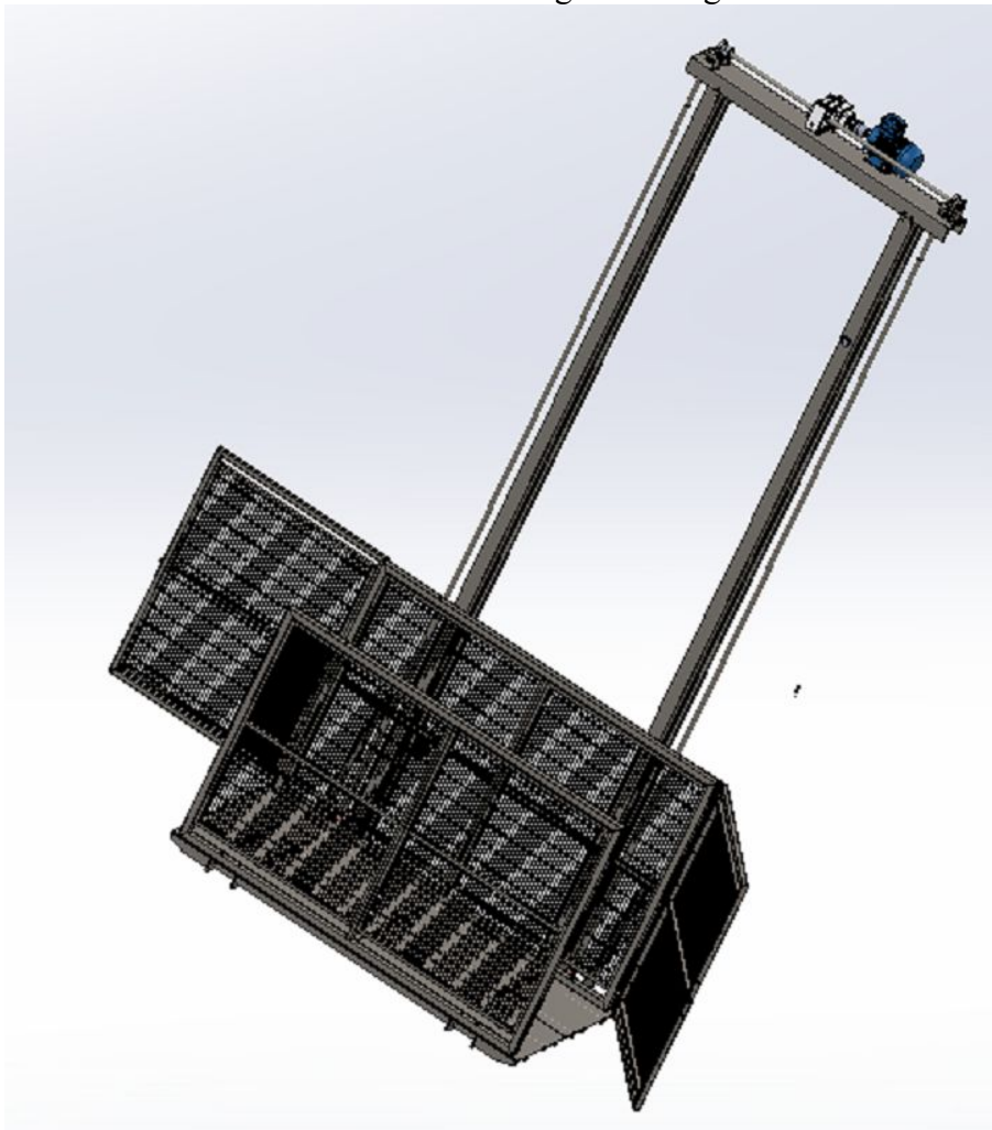
Slika 8-7 Montirana zaštitna ograda na kabini
