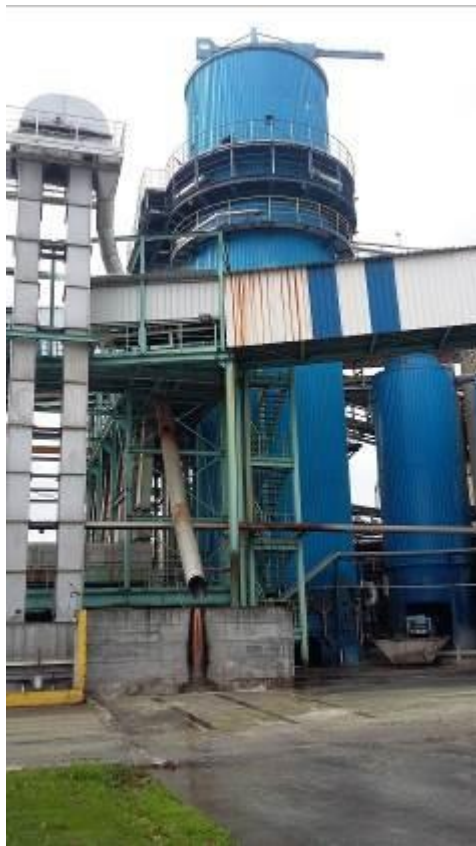
Slika 10. Vertikalni difuzni toranj [10]
