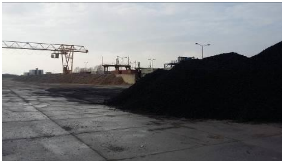
Slika 13. Koks za loženje u vapnenoj peći [10]
