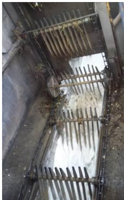
Slika 7. Hidraulički transport šećerne repe [10]
