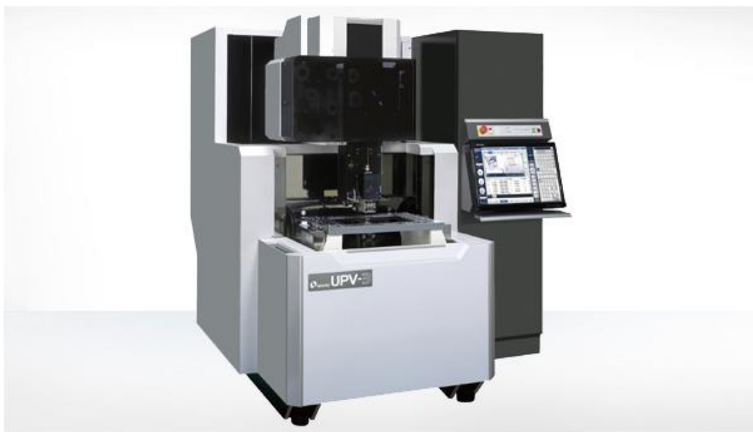
Slika 24. Uređaj za elektroerozijsko rezanje žicom [16]
