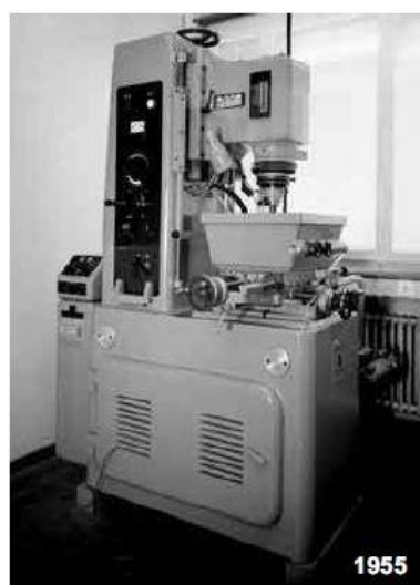
Slika 4. Uređaj za elektroeroziju [1]
