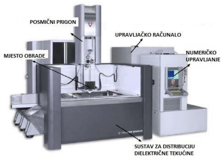
Slika 26. Elementi elektroerozijskog uređaja [2]
