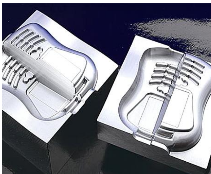
Slika 30. Primjer izratka elektroerozijskom obradom žigom [19]
