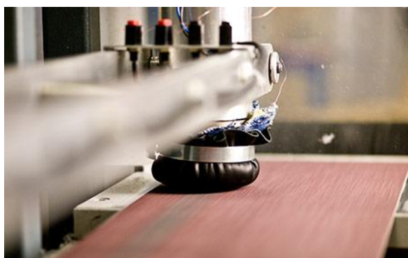
Slika 3. Ispitivanje uzorka prema standardu EN 13595-1:2002 [5]
