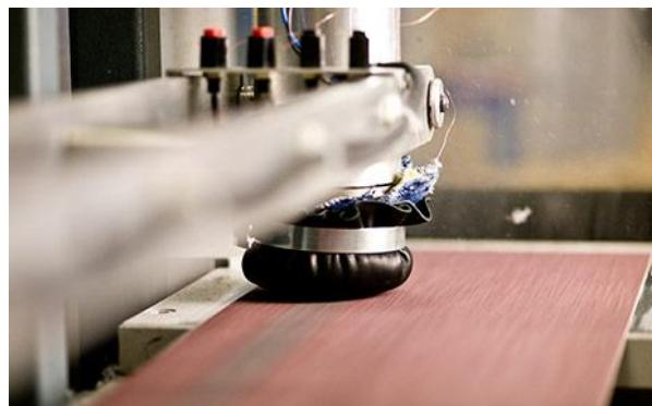
Slika 3. Ispitivanje uzorka prema standardu EN 13595-1:2002 [5]
