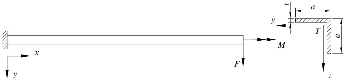
**Slika 4.8. Uklještena greda opterećena na savijanje i uvijanje**
