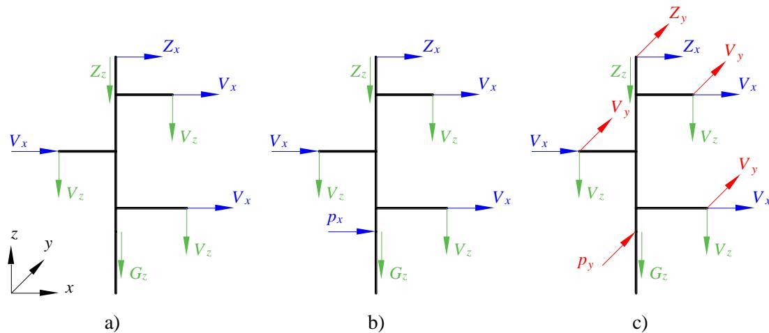
Slika 3.1. Redovni slučajevi opterećenja zateznog stupa
