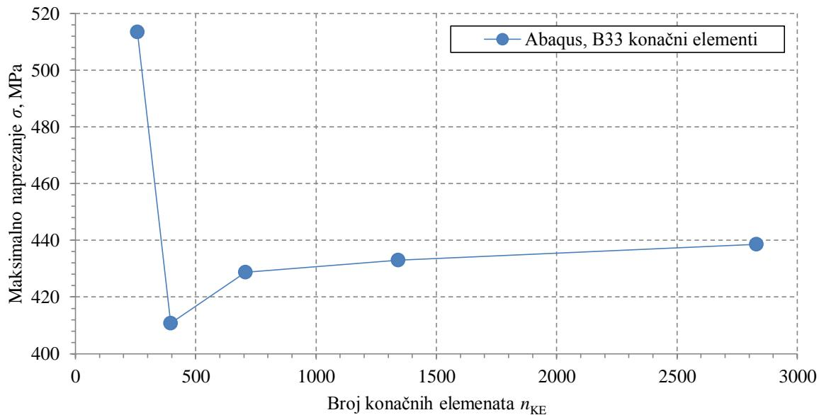
**Slika 6.12. Dijagram ovisnosti maksimalnog naprezanja  $\sigma$  / MPa o broju KE**
