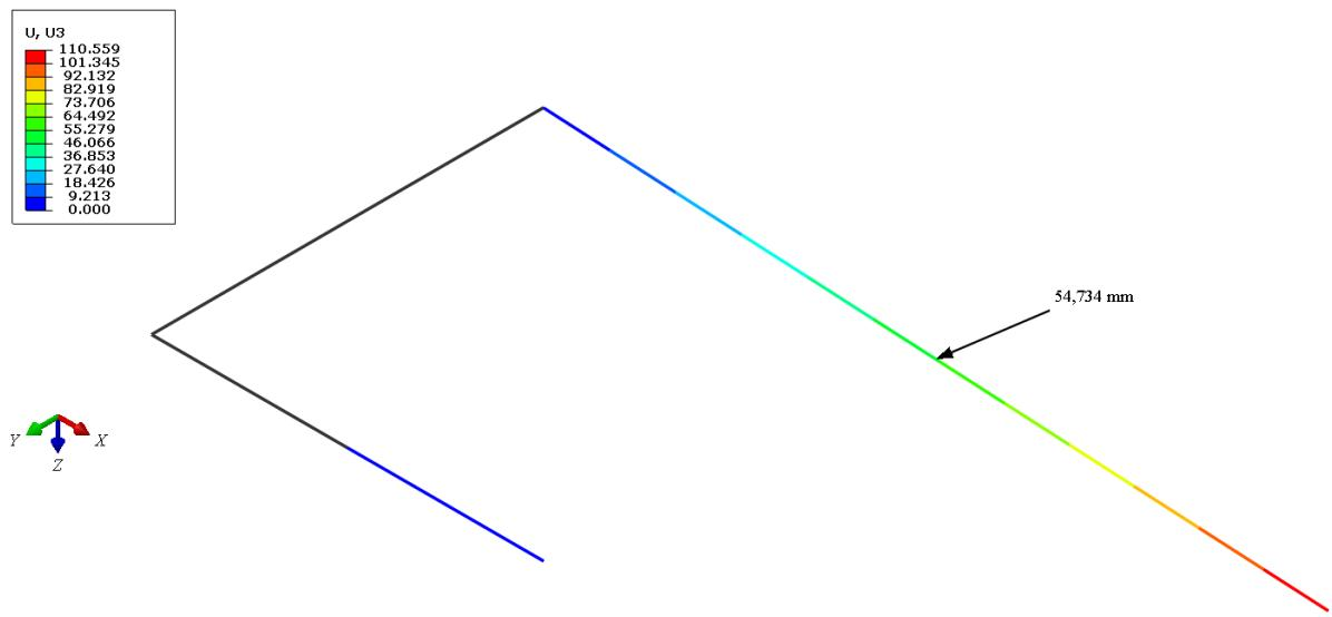
Slika 4.18. Primjer III, Abaqus – progib  $w_D / \text{mm}$
