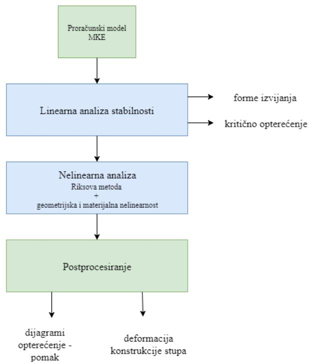
**Slika 6.2. Shematski prikaz procedure nelinearne analize stupa**
