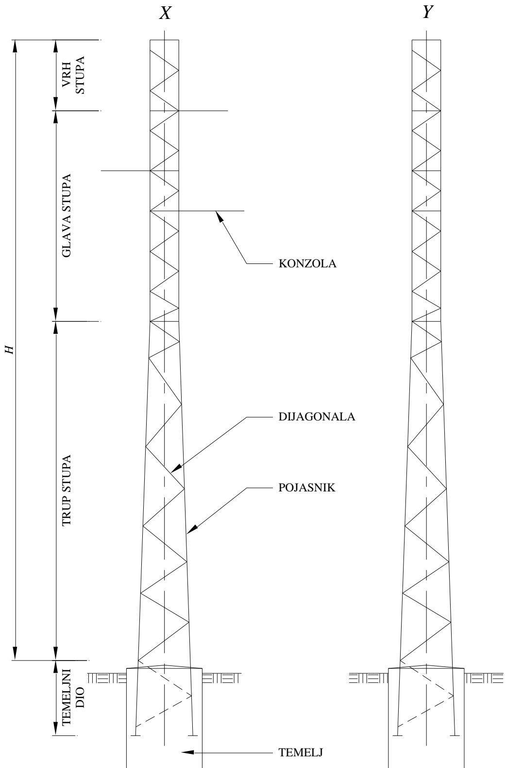
**Slika 2.1. Shema čeličnog rešetkastog stupa [5]**
