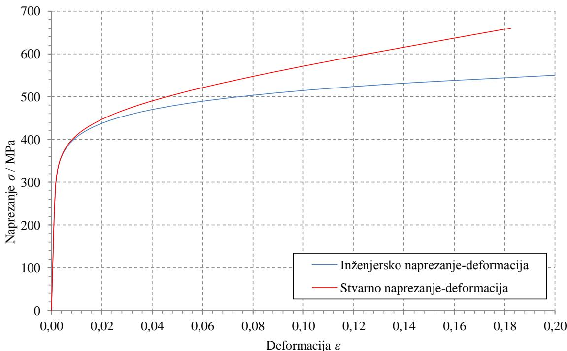
Slika 6.7. Dijagram naprezanje – deformacija materijala S355J2
