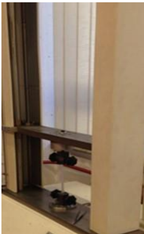
Slika 28. Uređaj za ispitivanje vlačne čvrstoće i istežljivosti
