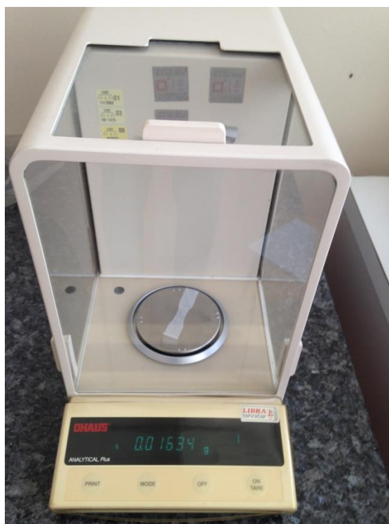
Slika 24. „Ohaus, Analytical plus“ analitička vaga
