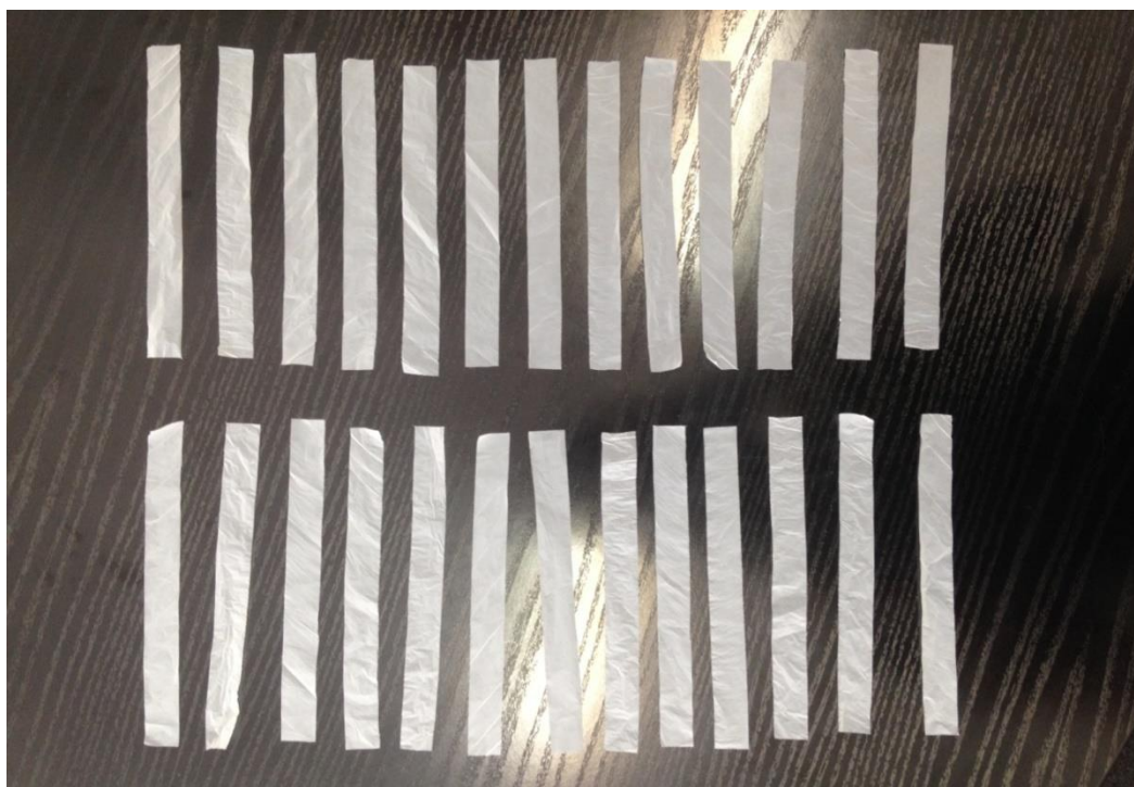
Slika 27. Izrezane epruvete za ispitivanje vlačne čvrstoće i istežljivosti sukladne normi
