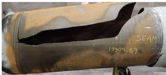
Slika 4. Krhki lom posude pod tlakom [3]
