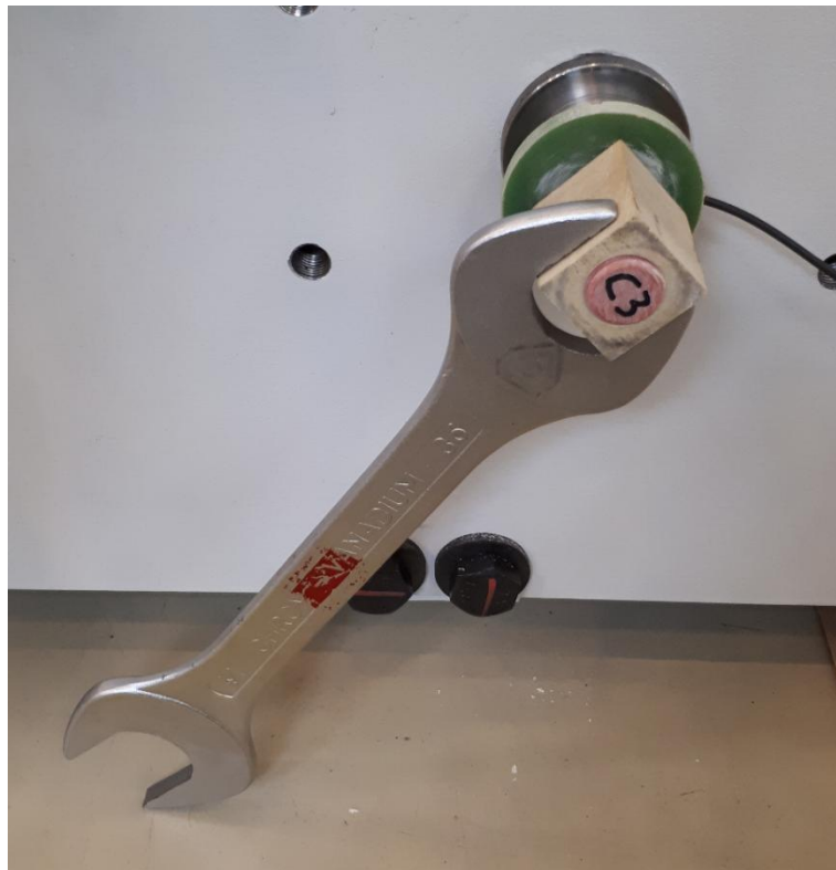
Slika 36. Sprečavanje zakretanja matice uz pomoć viličastog ključa
