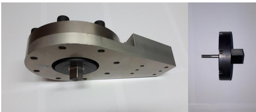
Slika 18. Spoj glave pretvornika i četverobridnog nastavka
