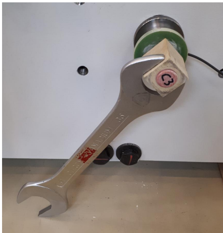
Slika 36. Sprečavanje zakretanja matice uz pomoć viličastog ključa
