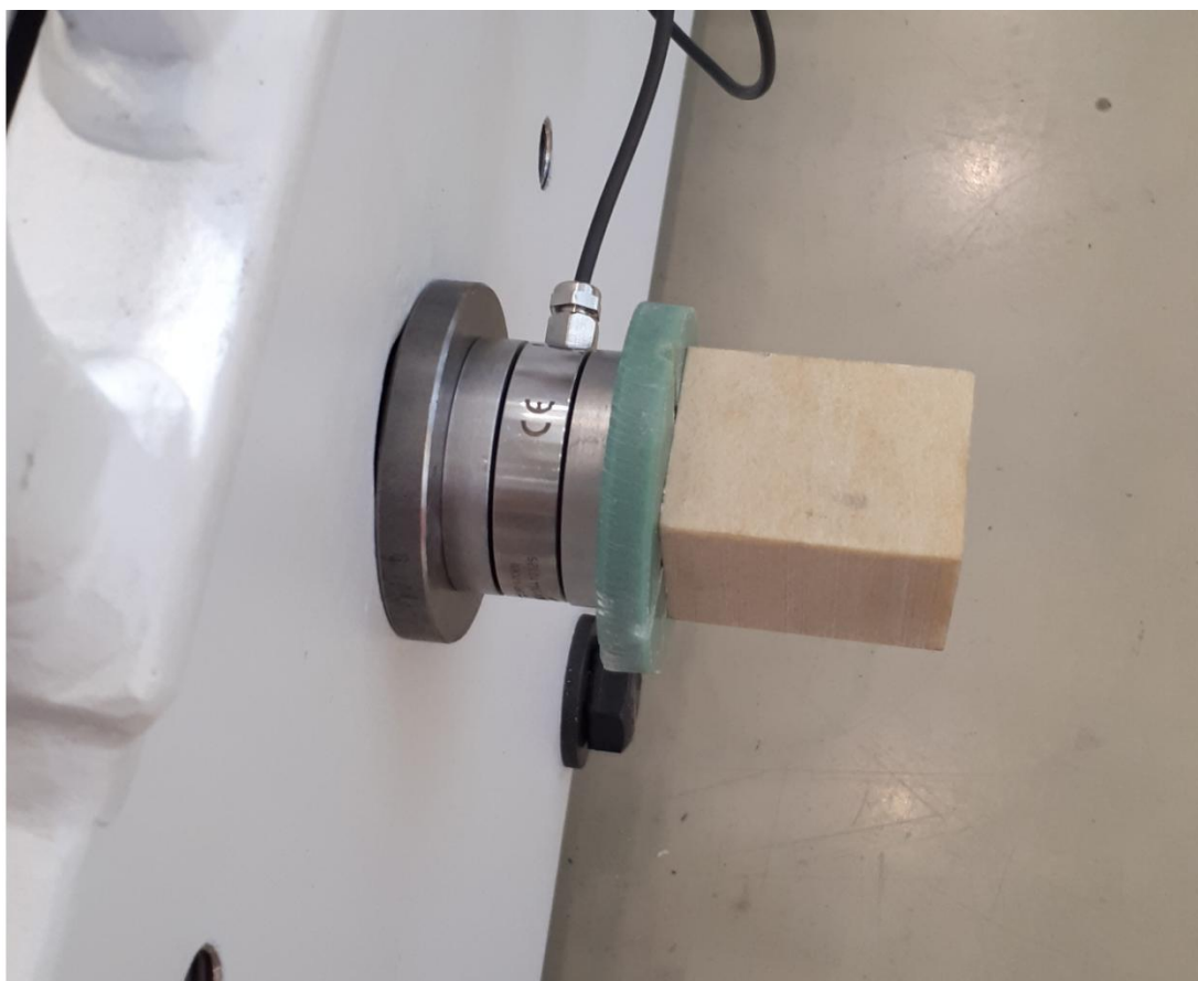
Slika 34. Postavljanje mjernog pretvornika sile
