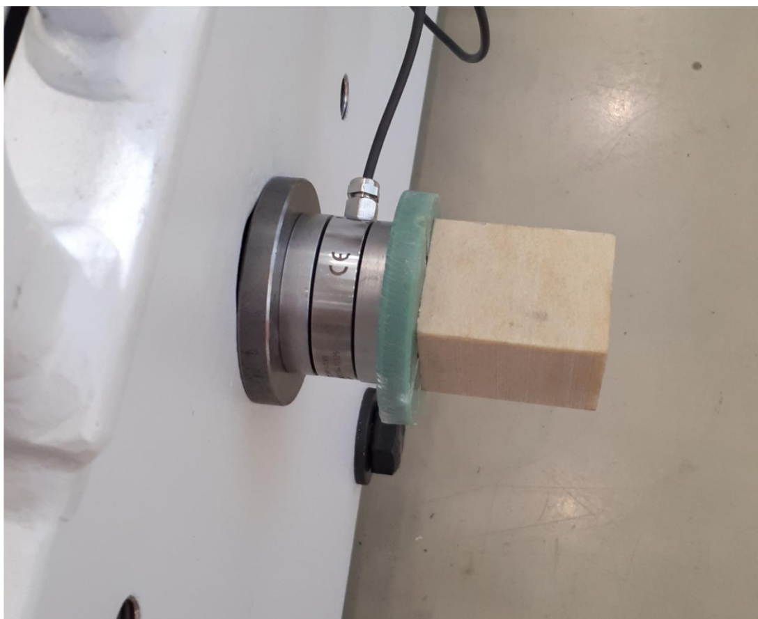
Slika 34. Postavljanje mjernog pretvornika sile
