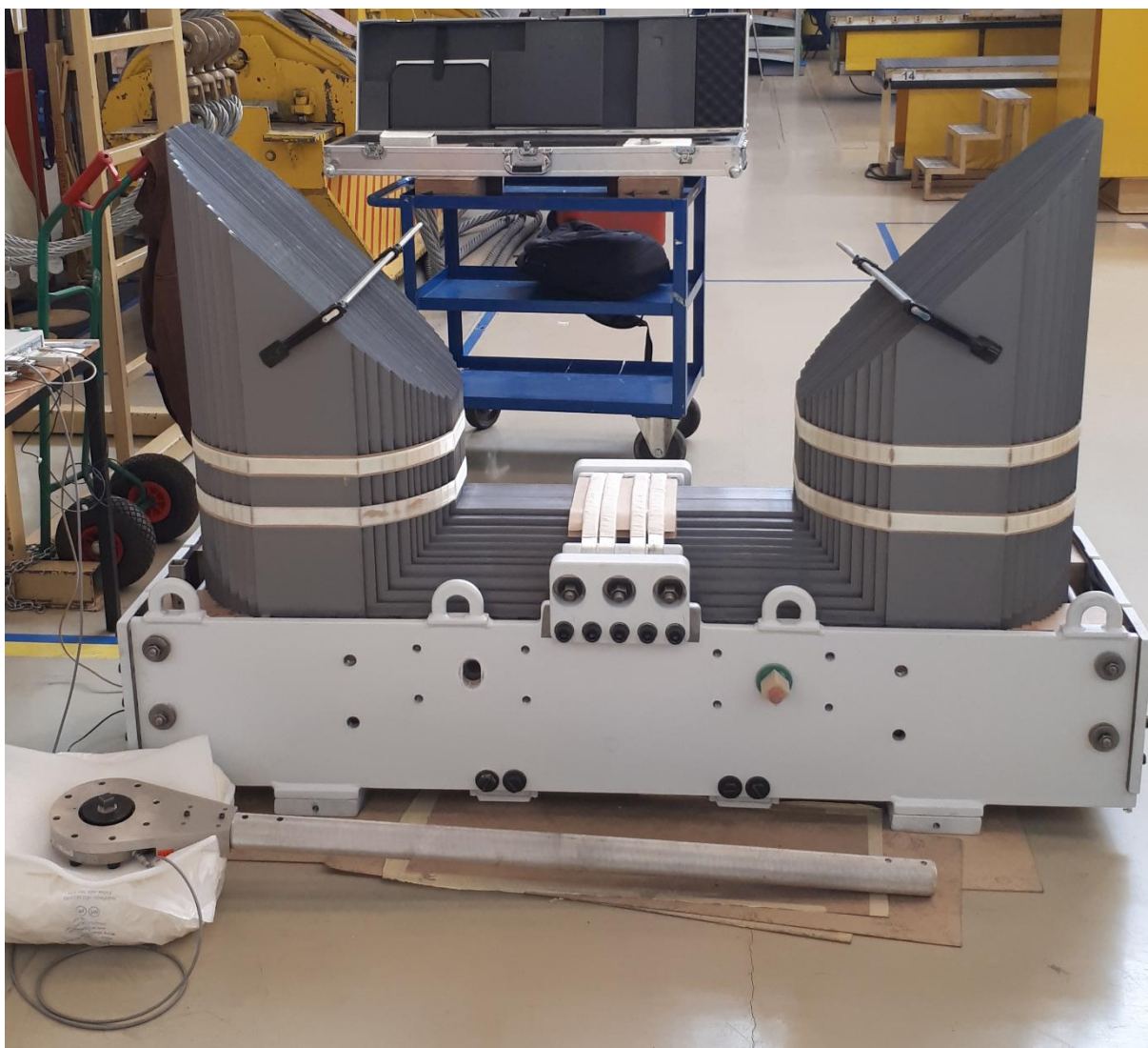
Slika 29. Stvarni ispitni model jezgre
