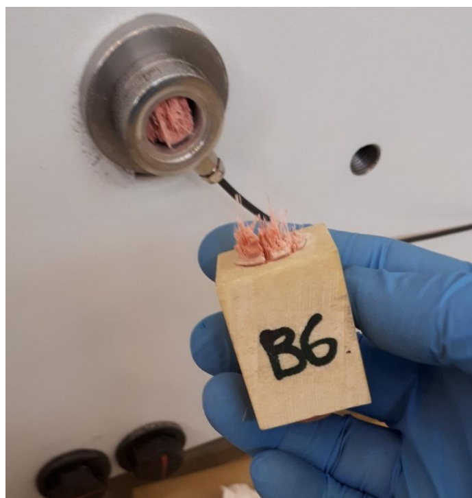
Slika 45. Konačni lom uzorka B6 na strani mjernog pretvornika KMR 300
