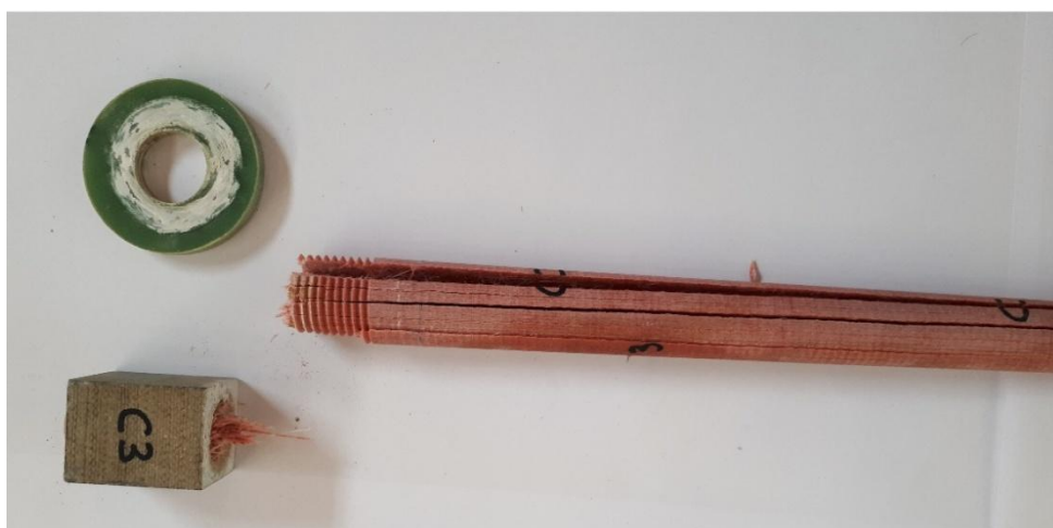
Slika 42. Prikaz uzdužnog i poprečnog loma uzorka C3
