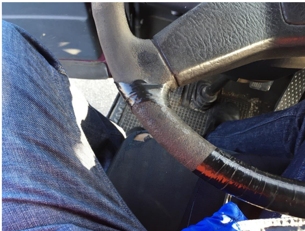
Slika 4.8. Prikaz oštećenja na oblozi kola volana
