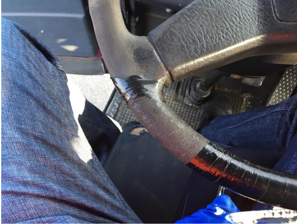
Slika 4.8. Prikaz oštećenja na oblozi kola volana
