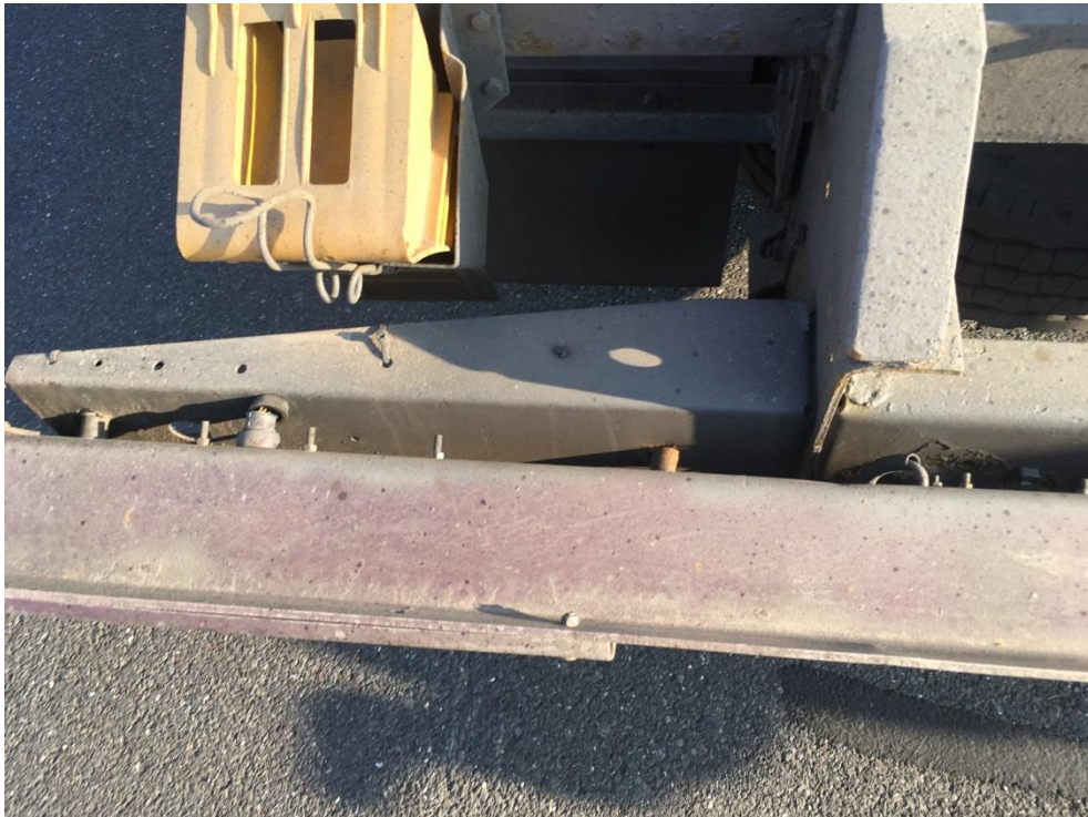
Slika 4.9. Prikaz savijenog zadnjeg odbojnika i popucanih vijaka
