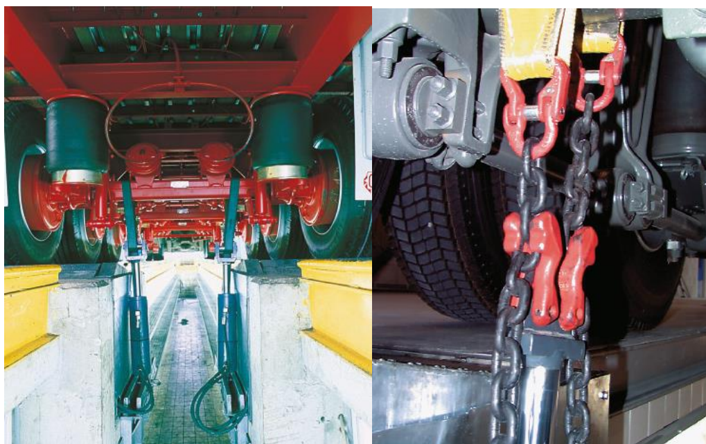
Slika 10. Povlačenje osovine sa hidraulikom[8]
