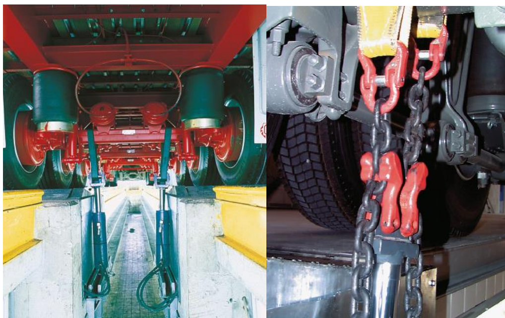
Slika 10. Povlačenje osovine sa hidraulikom[8]
