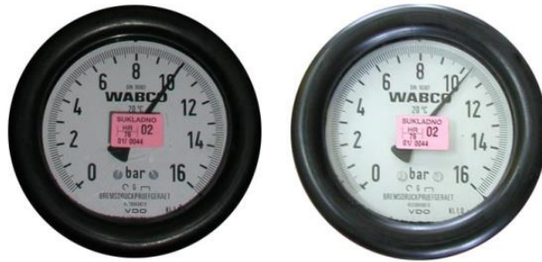
Slika 2. Manometri sa prikazom tlaka kod nereducirane kočne instalacije
