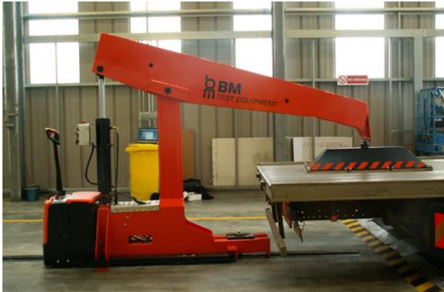
Slika 9. Mobilni uređaj za opterećivanje tovarnog prostora vozila[7]
