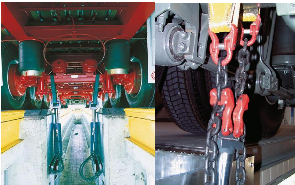
Slika 10. Povlačenje osovine sa hidraulikom[8]
