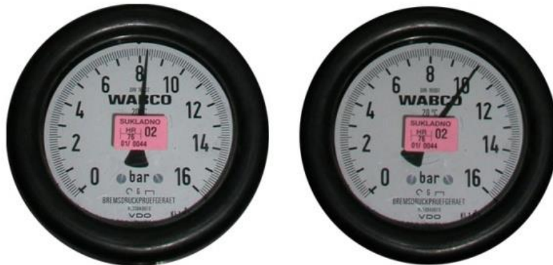
Slika 3. Manometri sa prikazom tlaka kod reducirane kočne instalacije
