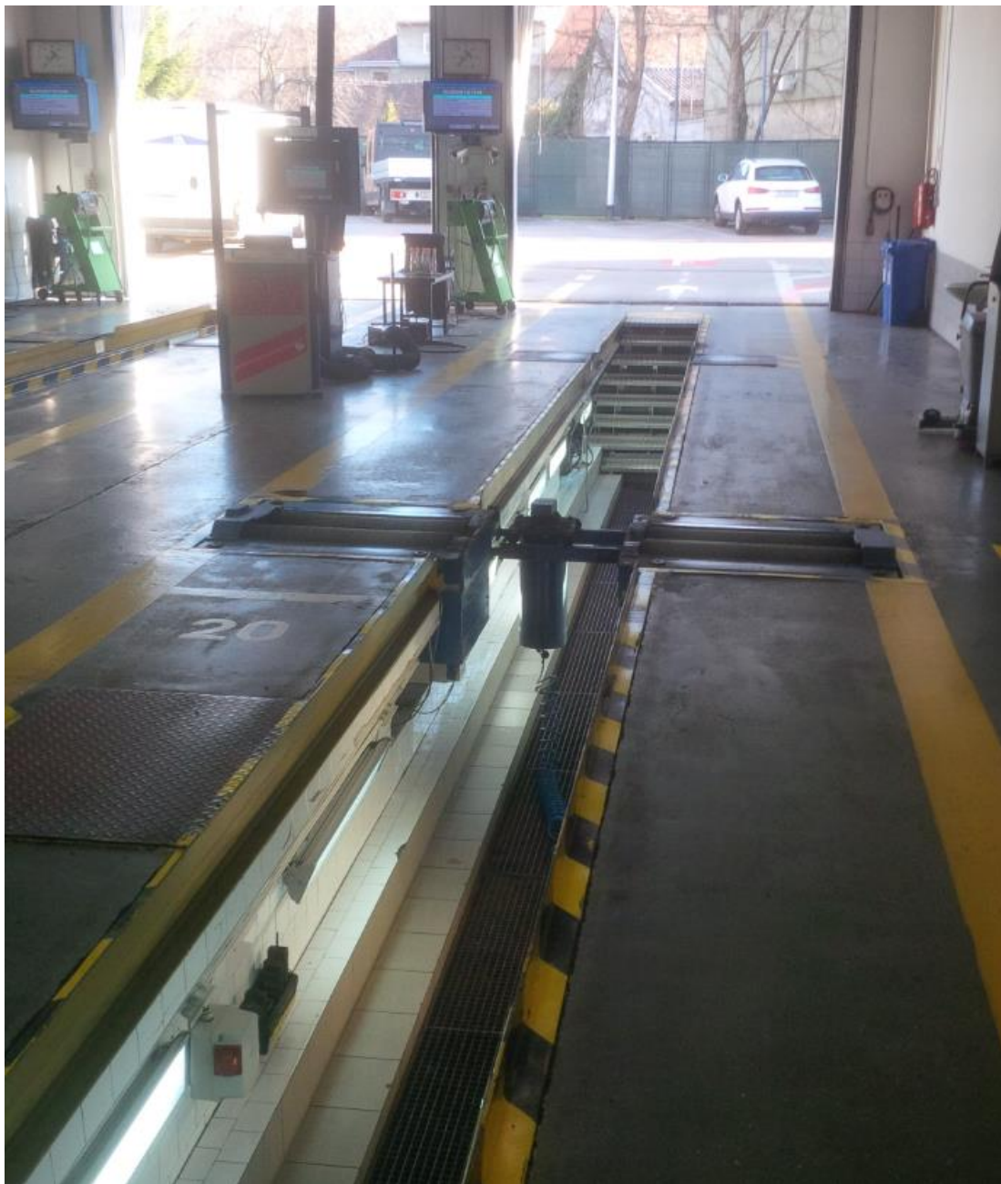
Slika 5. Kanal za tehnički pregled vozila
