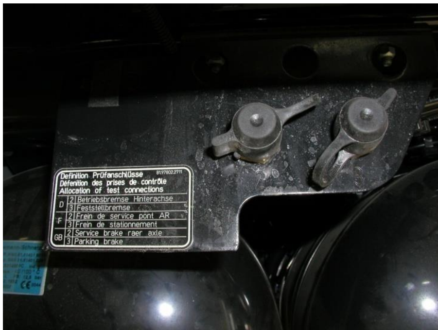
Slika 1. Kontrolni priključci za spajanje manometra
