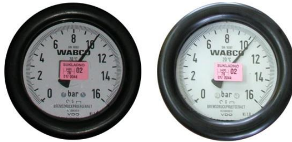
Slika 2. Manometri sa prikazom tlaka kod nereducirane kočne instalacije
