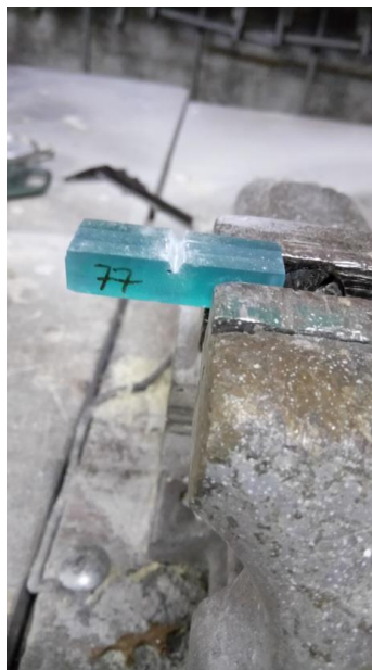
Slika 53. Urezivanje V-utora na ispitne uzorke
