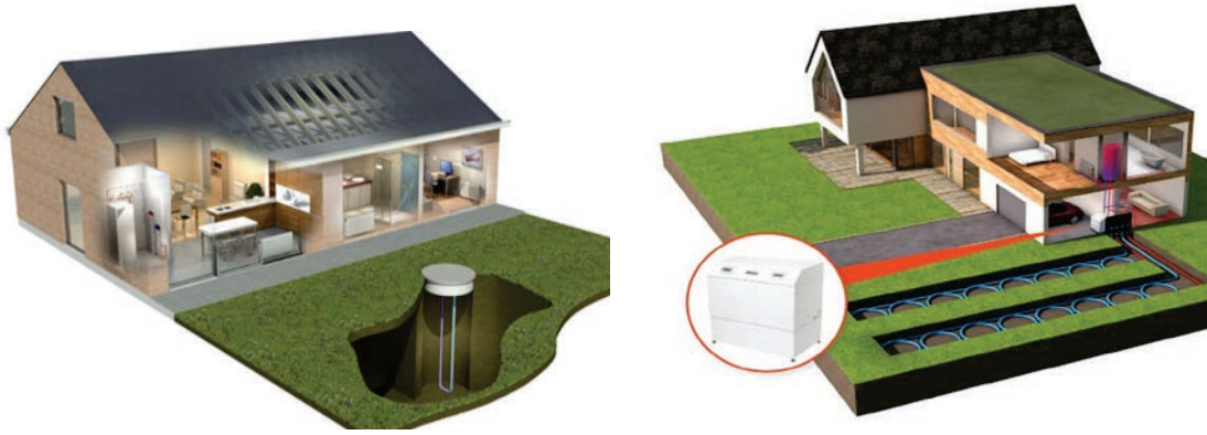
Slika 7: Geotermalna sonda i vodoravno kolektorsko polje [16]
