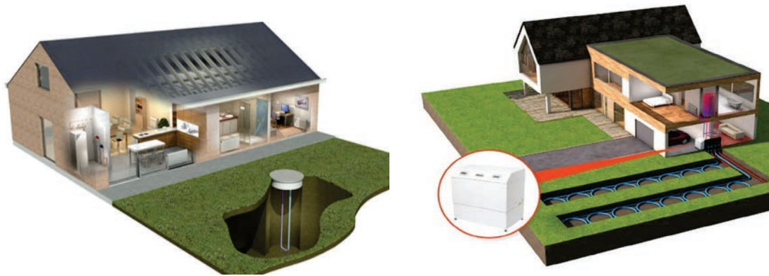
Slika 7: Geotermalna sonda i vodoravno kolektorsko polje [16]
