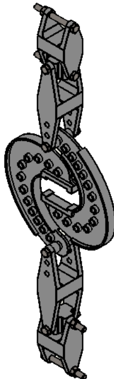
Slika 41. Prostorni prikaz okvirne konstrukcije koncepta Arcan prihvata
