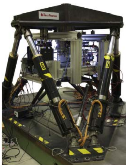
Slika 24. 6-osni stroj s kamerama i DIC [17]
