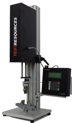
Slika 31. 100 Serija modularni standardni stroj za ispitivanje na savijanje [4]
