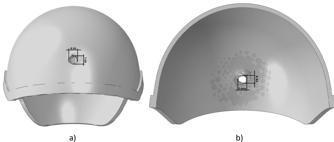
Slika 48. Rupa nastala prilikom sudara kacige i: a) polusfernog, b) konusnog zrna
