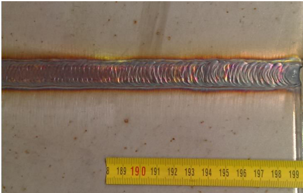
Slika 23. Izgled zavara ispitnog uzorka 1
