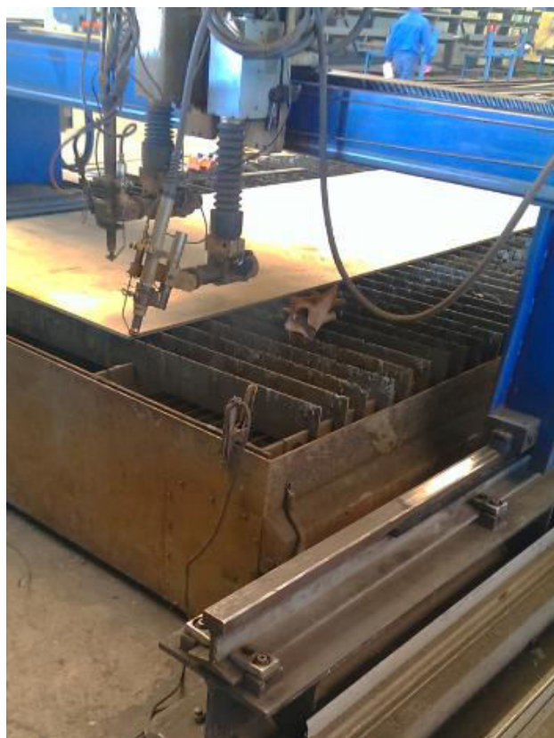
Slika 20. Rezanje uzorka na stroju ZINSER 2326 plazmom
