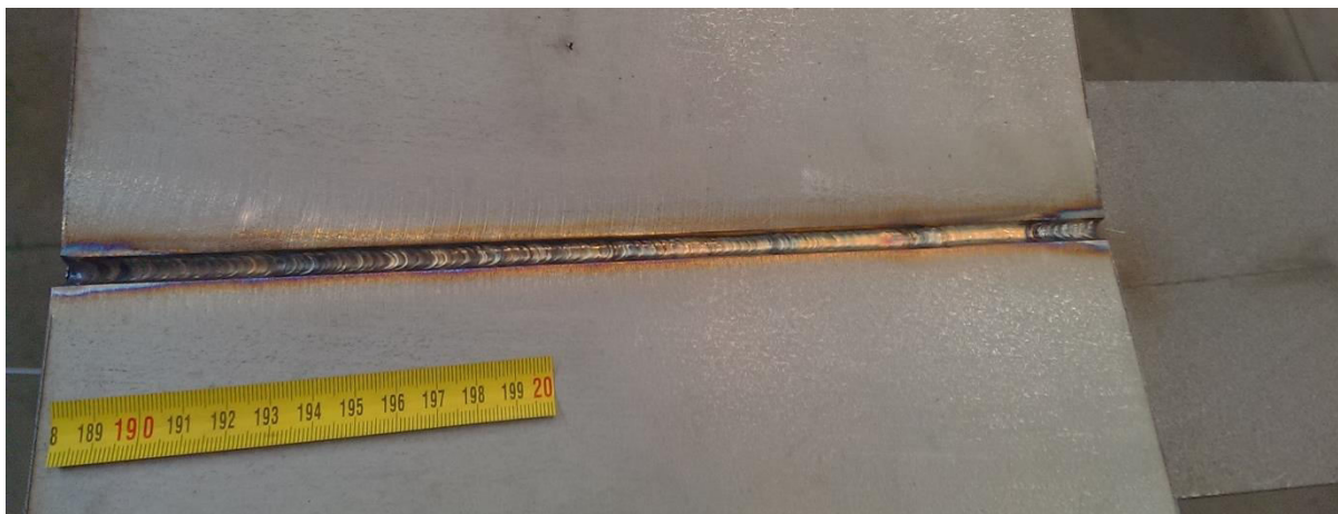
Slika 26. Zavareni spoj popune broj 1 ispitnog uzorka 2
