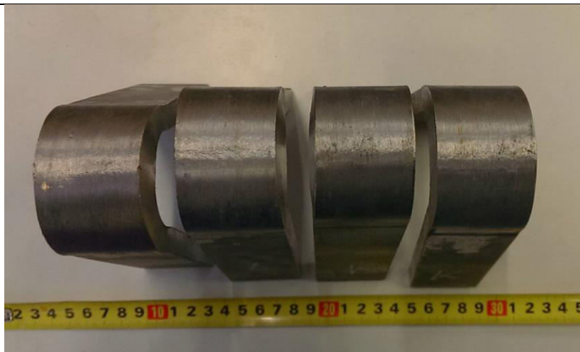
Slika 46. Rezultati savijanja epruveta ispitnog uzorka 2
