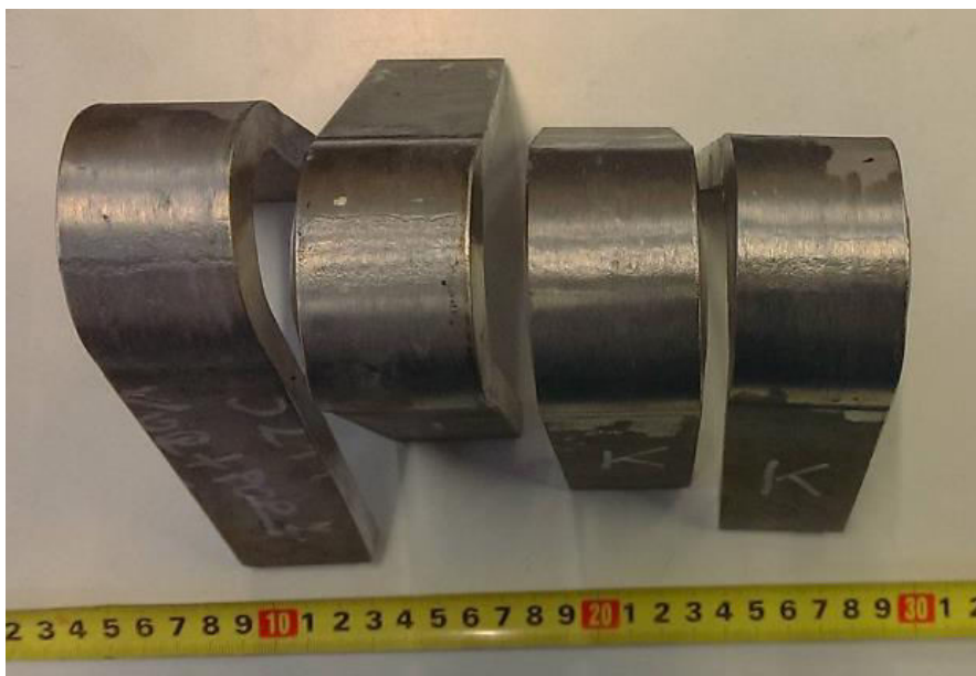
Slika 49. Rezultati savijanja epruveta ispitnog uzorka 5
