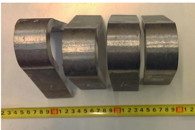
Slika 48. Rezultati savijanja epruveta ispitnog uzorka 4
