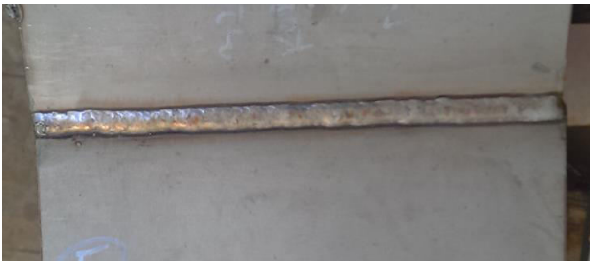
Slika 32. Završni sloj ispitnog uzorka 5
