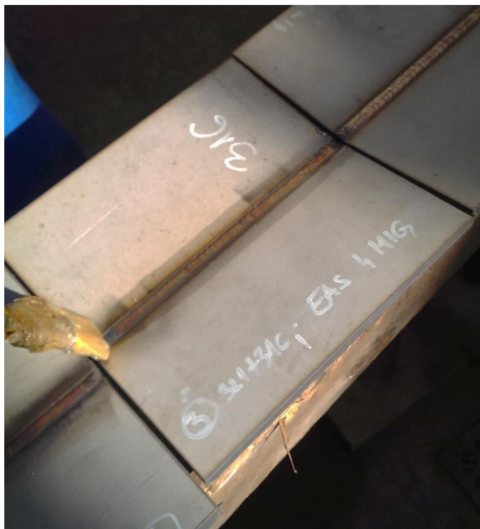
Slika 33. Nanošenje BEIZPASTE kistom
