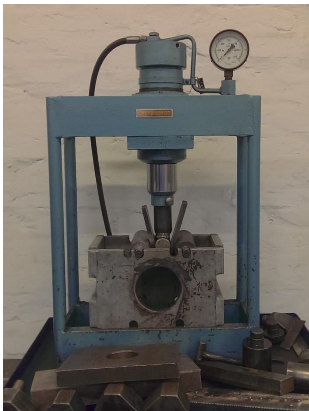
Slika 44. Savijanje ispitnih uzoraka na FSB-u
