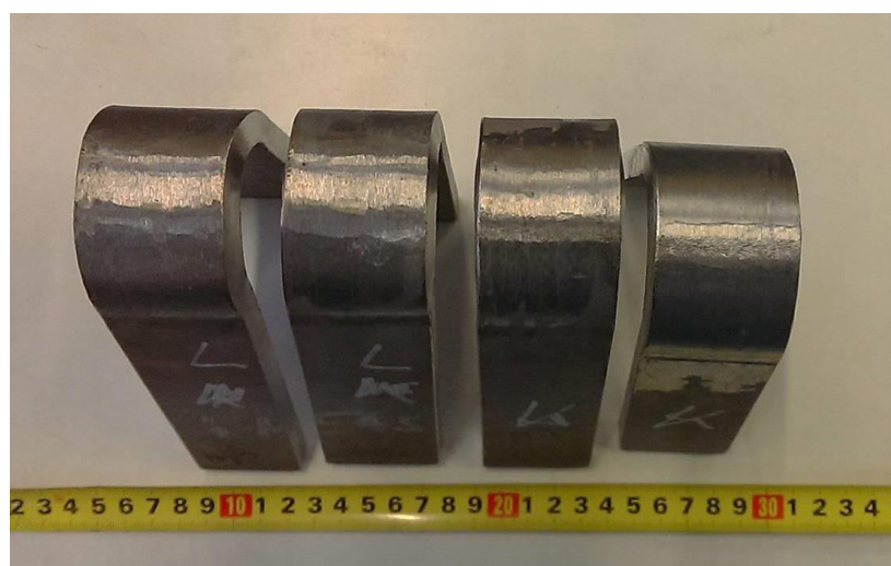
Slika 47. Rezultati savijanja epruveta ispitnog uzorka 3
