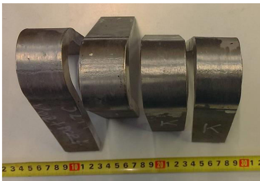
Slika 49. Rezultati savijanja epruveta ispitnog uzorka 5
