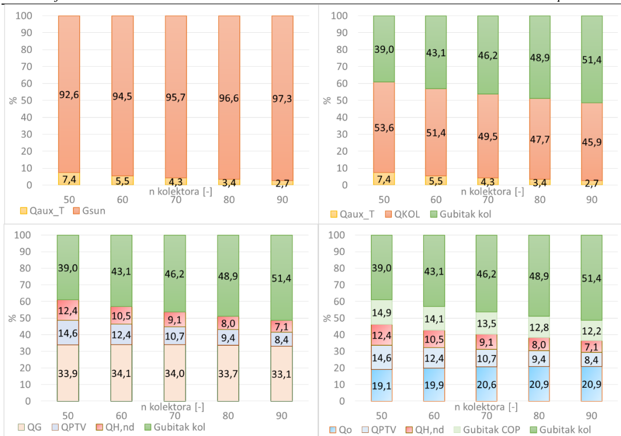
Slika 3.41. Tijek pretvorbe 100% pogonske energije u korisnu energiju, rashladni učin i gubitke sustava
