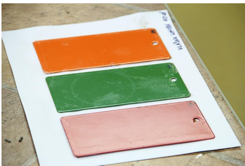
Slika 46. Stanje uzoraka nakon 240 sati ispitivanja u vlažnoj komori
