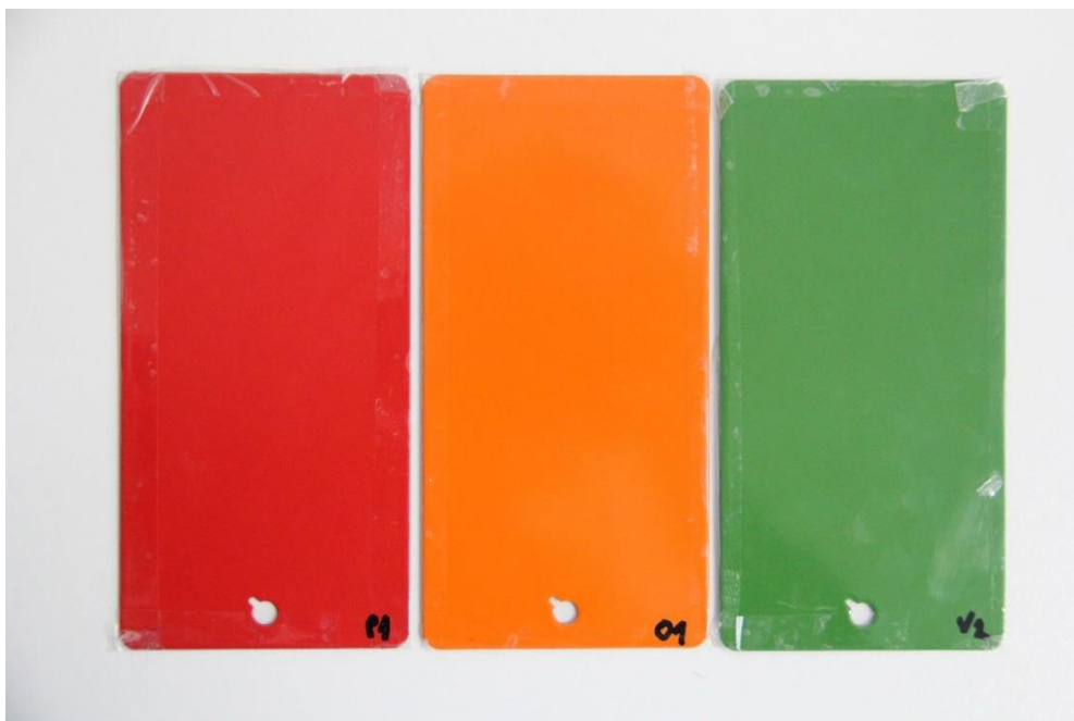
Slika 44. Uzorci spremni za ispitivanje u vlažnoj komori
