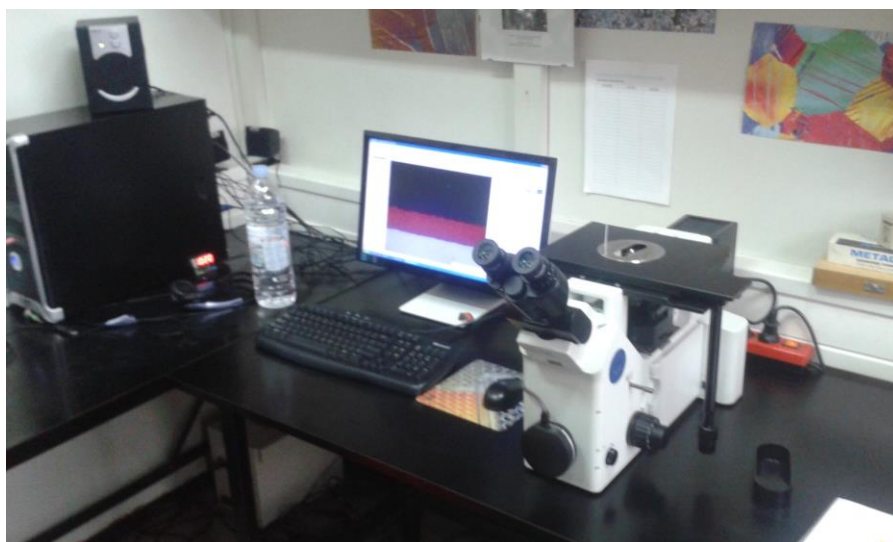
Slika 75. Analiza poroznosti premaza na mikroskopu Olympus GX51
