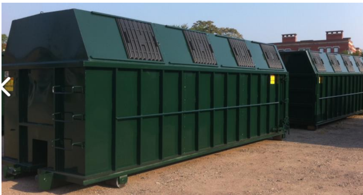
Slika 8. Vodorazrjedivi epoksi premaz na metalnim kontejnerima [32]
