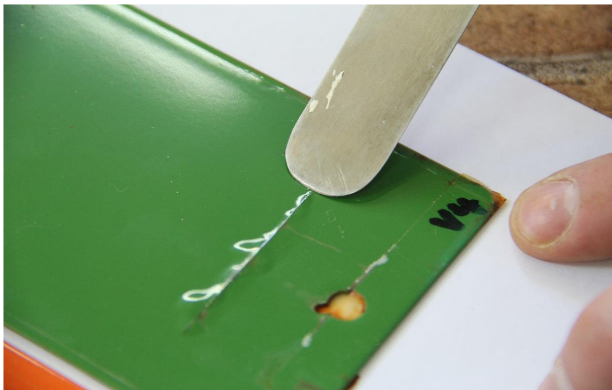
Slika 36. Odstranjivanje premaza na mjestu ureza nakon 240 sati izlaganja uvjetima slane komore
