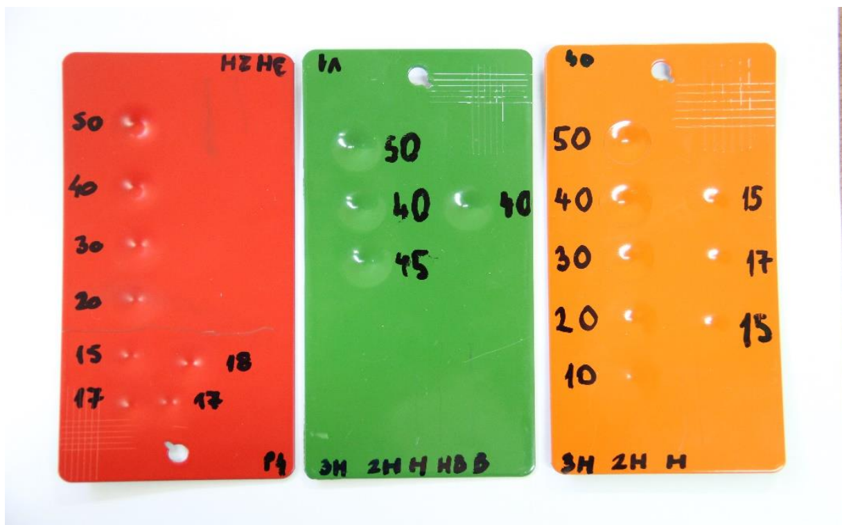
Slika 29. Rezultati ispitivanja otpornosti premaza na udar
