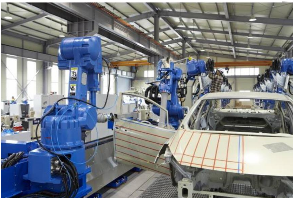
Slika 6. Roboti za nanošenje premaza [27]
