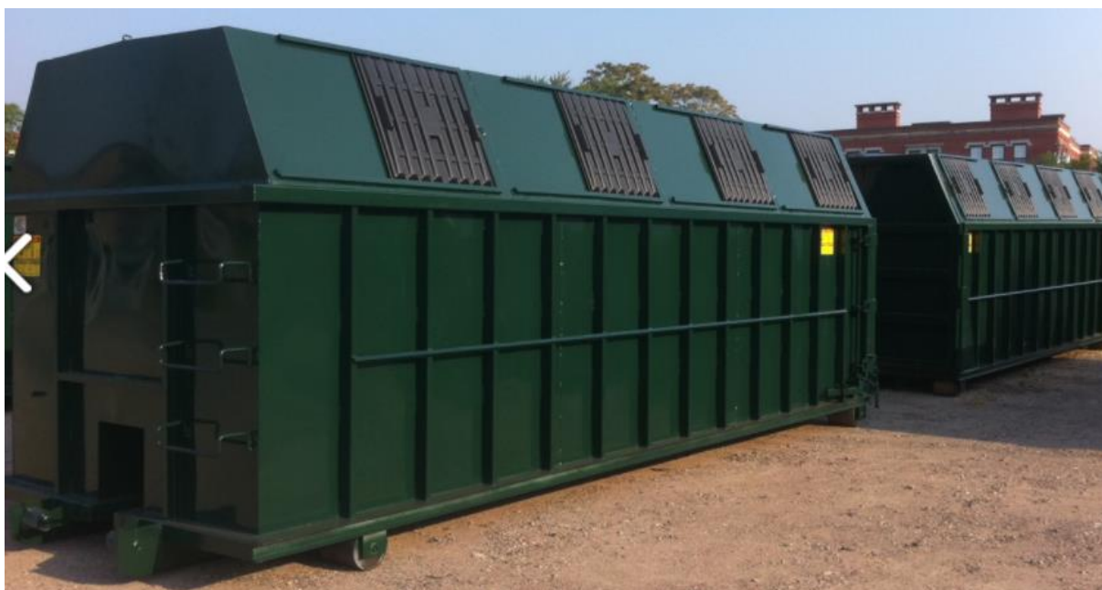
Slika 8. Vodorazrjedivi epoksi premaz na metalnim kontejnerima [32]
