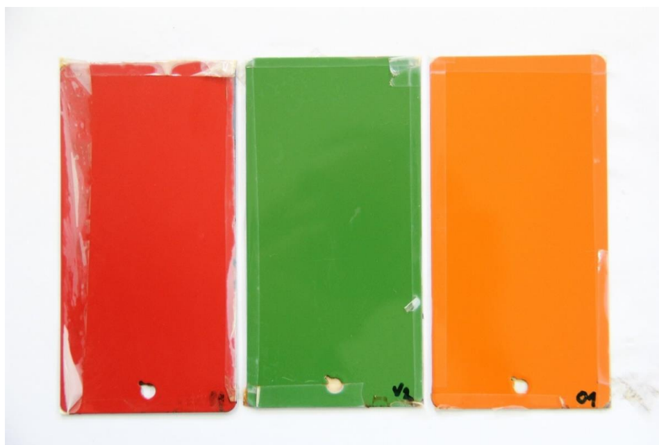
Slika 47. Uzorci nakon 240 sati ispitivanja u vlažnoj komori
