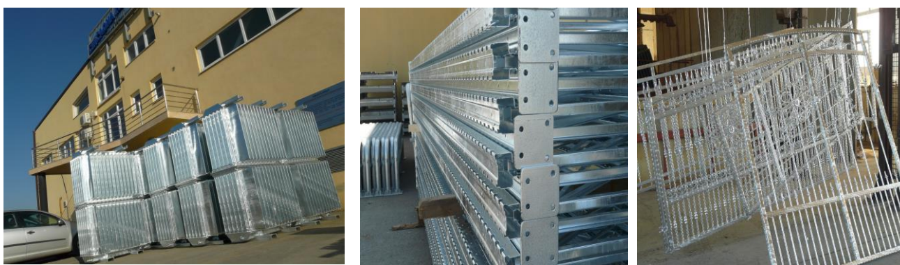
Slika 1. Metalne konstrukcije nakon postupka vrućeg pocinčavanja [9]
