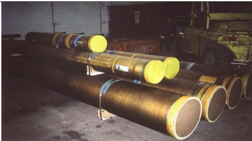
Slika 7. Zaštita unutrašnjosti čeličnih cijevi tijekom skladištenja [19]
