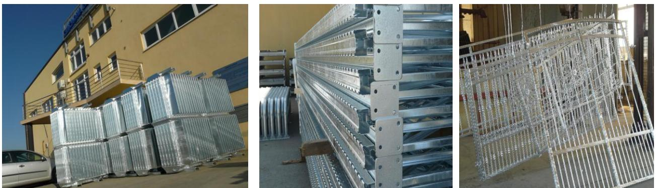
Slika 1. Metalne konstrukcije nakon postupka vrućeg pocinčavanja [9]
