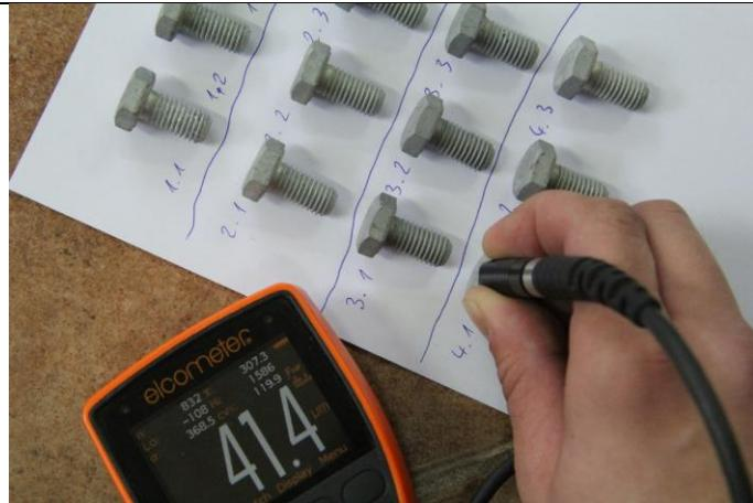
**Slika 13. Mjerenje debljine prevlake cinka uredajem ELCOMETER 456/4**
