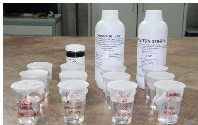
**Slika 14. Prikaz uzorka nakon uranjanja u posudice vodovodne vode, destilirane vode, te otopine NaCl-a s inhibitorima korozije**
