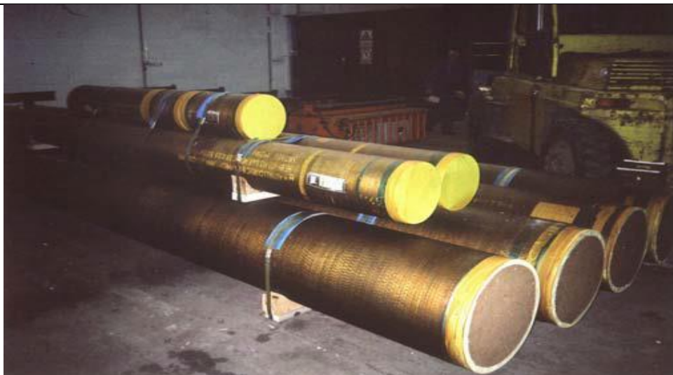
Slika 7. Zaštita unutrašnjosti čeličnih cijevi tijekom skladištenja [19]
