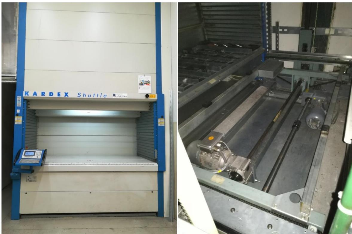
**Slika 3. Izvedba vertikalnog podiznog modula**
