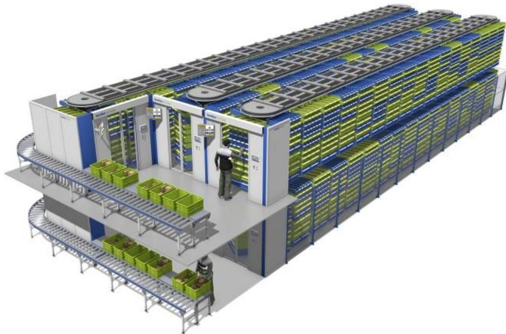
**Slika 27. Višeetažni horizontalni karusel s fiksni platformama [6]**
