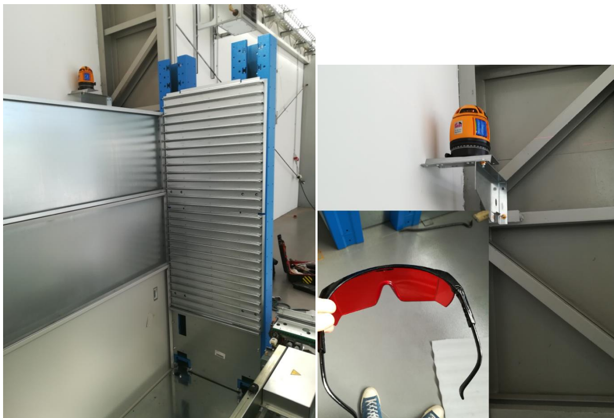
Slika 32. Postupak niveliranja Shuttle sustava
