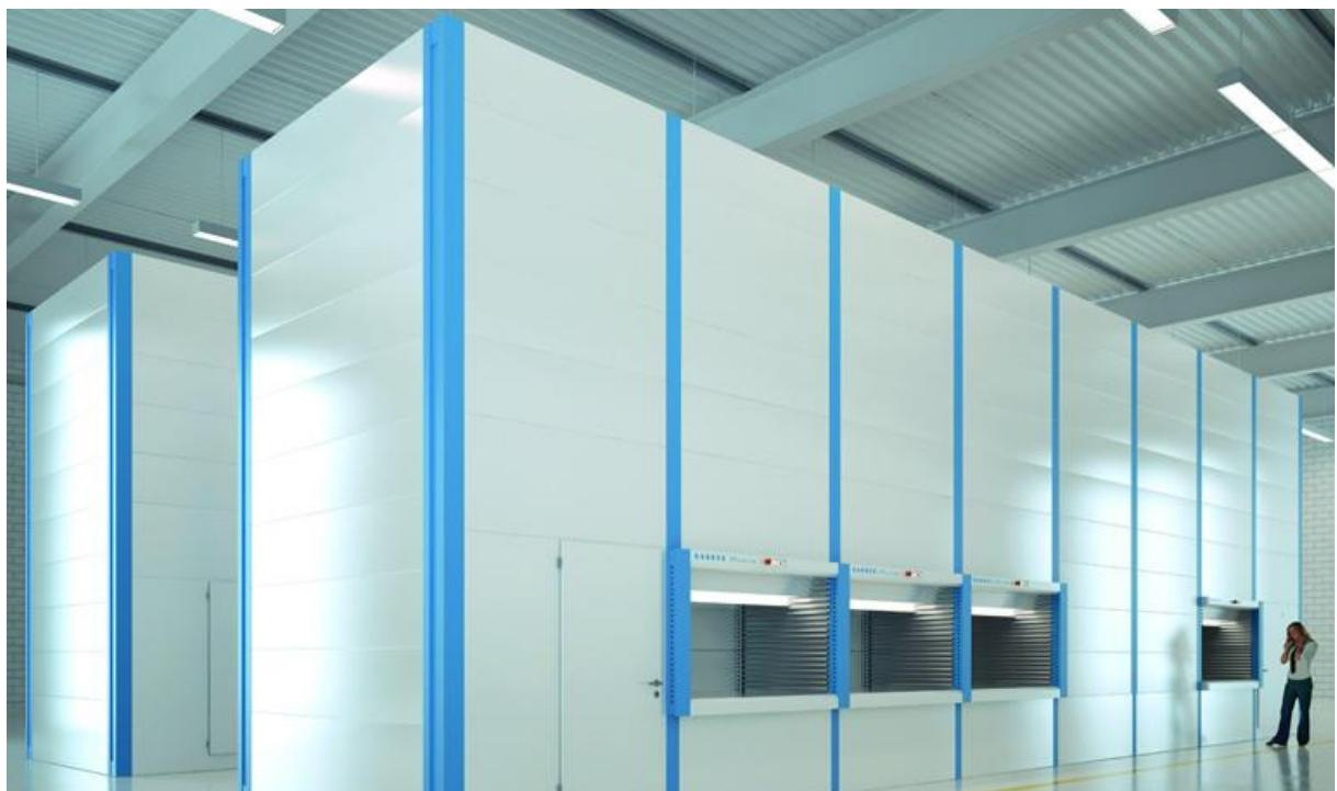
Slika 8. Radna stanica s više modula uz mogućnost uzdužnog pomicanja ekstraktora [6]
