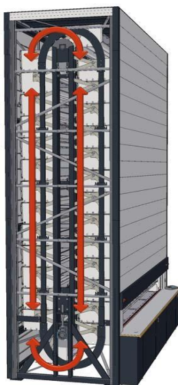
Slika 23. Princip rada Megamat RS sustava – paternoster [9]
