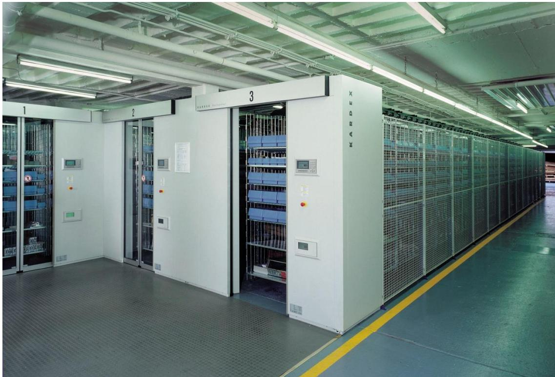
**Slika 6. Izvedba automatiziranog horizontalnog karusela [5]**
