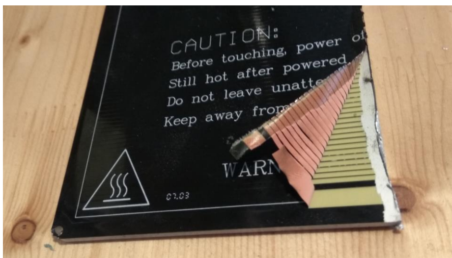
Slika 2.11. Bakrena zavojnica grijaće ploče
