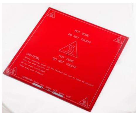
Slika 2.10. Grijaća ploča postolja [1]
