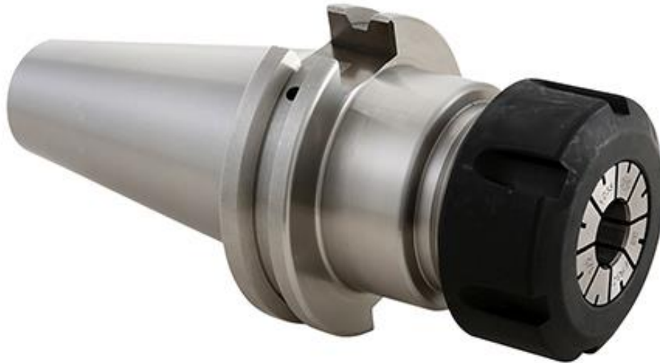
Slika 27. Stezni sustav alata s elastičnom čahurom [23]
