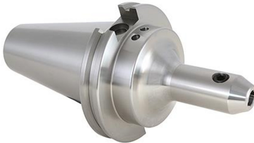
Slika 31. Stezni sustav s cilindričnom drškom [23]
