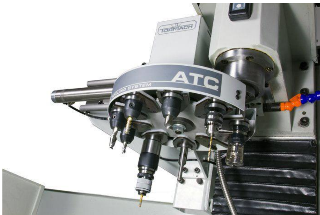
Slika 11. Automatski izmjenjivač alata tvrtke TORMACH [9]
