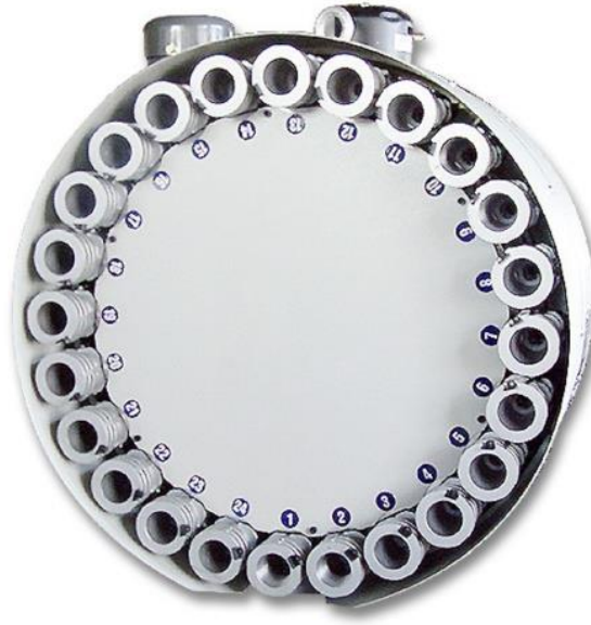
Slika 17. Disk magazin alata [15]
