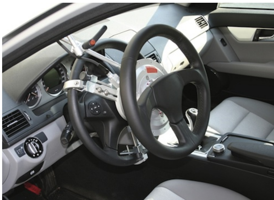
Slika 12. Mehaničko zaključavanje kuta zakreta upravljača [8]
