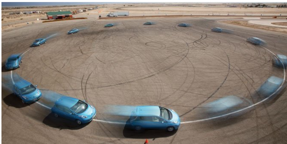
Slika 10. Ispitivanje metodom konstantnog polumjera [6]
