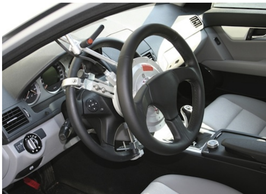
Slika 12. Mehaničko zaključavanje kuta zakreta upravljača [8]
