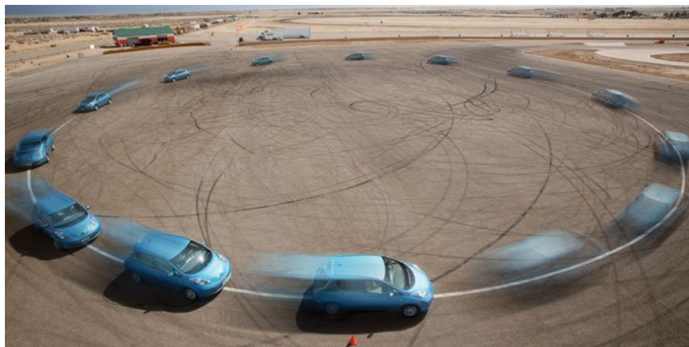
Slika 10. Ispitivanje metodom konstantnog polumjera [6]
