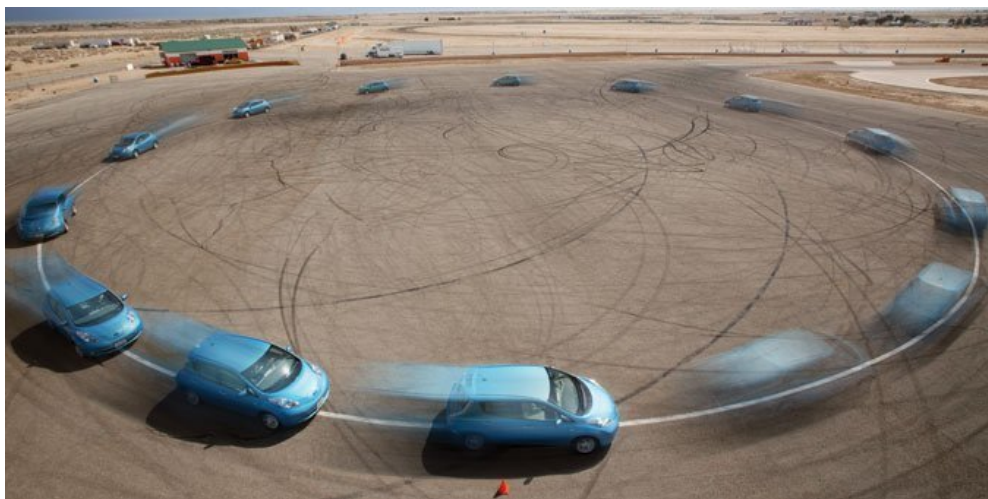
Slika 10. Ispitivanje metodom konstantnog polumjera [6]
