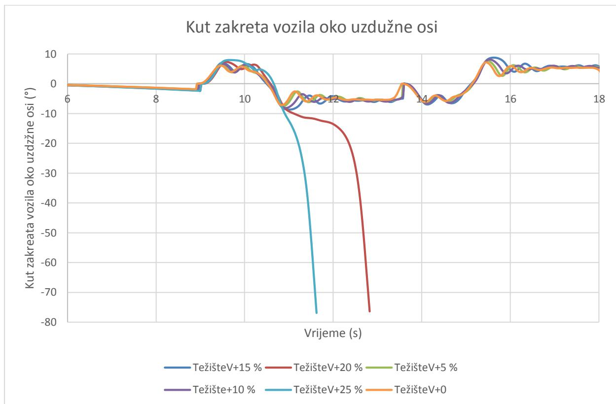
**Slika 98. Kut zakreta vozila oko uzdužne osi, Fishhook, pomak težišta u vertikalnom smjeru**
