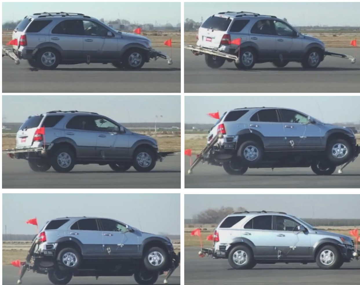
Slika 10. Izvođenje Fishhook ispitne procedure na vozilu s značajnom opasnošću prema prevrtanju
