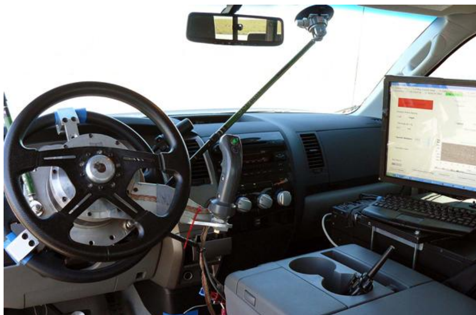
Slika 9. Uređaj za robotizirano upravljanje upravljačem
