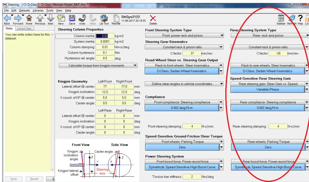
Slika 57. Definiranje upravljačkog sustava na stražnjoj osovini
