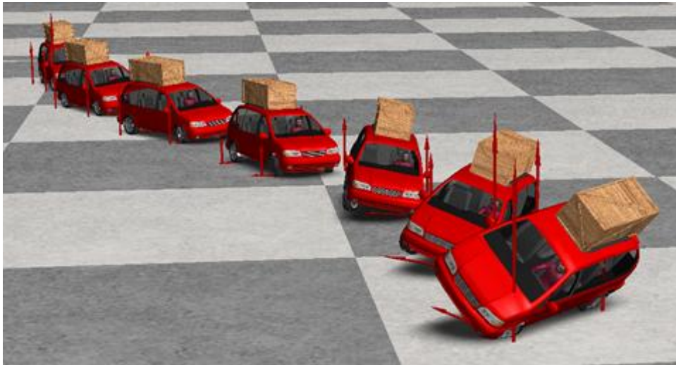
Slika 105. Animacija prevrtanja vozila, Fishhook, teret na krovu
