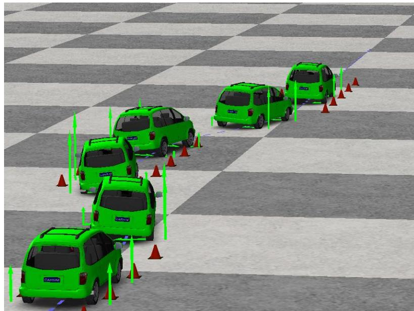
Slika 8. Simulacija dvostrukе izmjene pravca u CarSim programskom paketu
