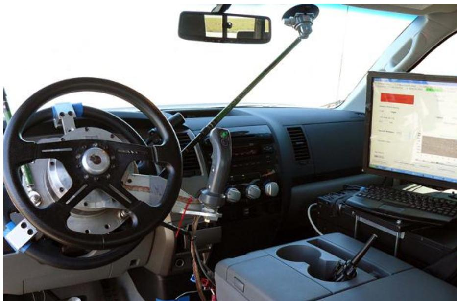
Slika 9. Uredaj za robotizirano upravljanje upravljačem
