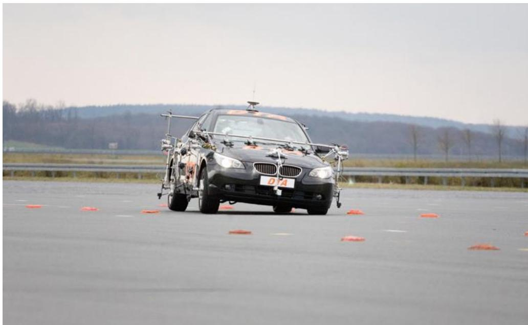
Slika 7. Vozilo opremljeno senzorima i mjernim instrumentima za ispitnu proceduru dvostrukе izmjene pravca
