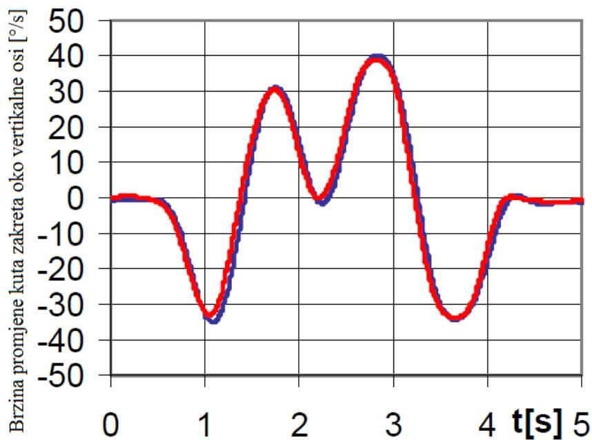
Slika 48. Brzina promjene kuta zakra otkriva vertikalne osi [ $^{\circ}/s$ ]; Crveno - rezultati IKA simulacije, Plavo - rezultati stvarnog ispitivanja
