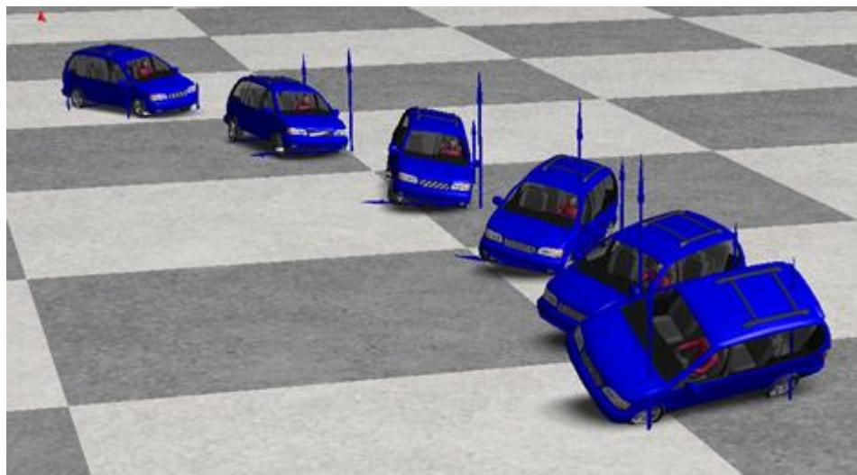
**Slika 99. Prevrtanje vozila, Fishhook, pomak težišta u vertikalnom smjeru**
