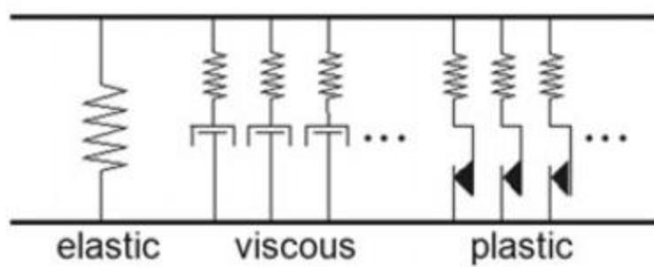
Slika 23. Prikaz simulacijskog modela materijala pneumatika [8.]
