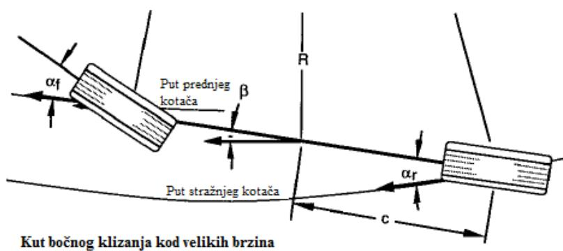
Slika 28. Usporedba kuta bočnog klizanja kod velikih i malih brzina [7.]
