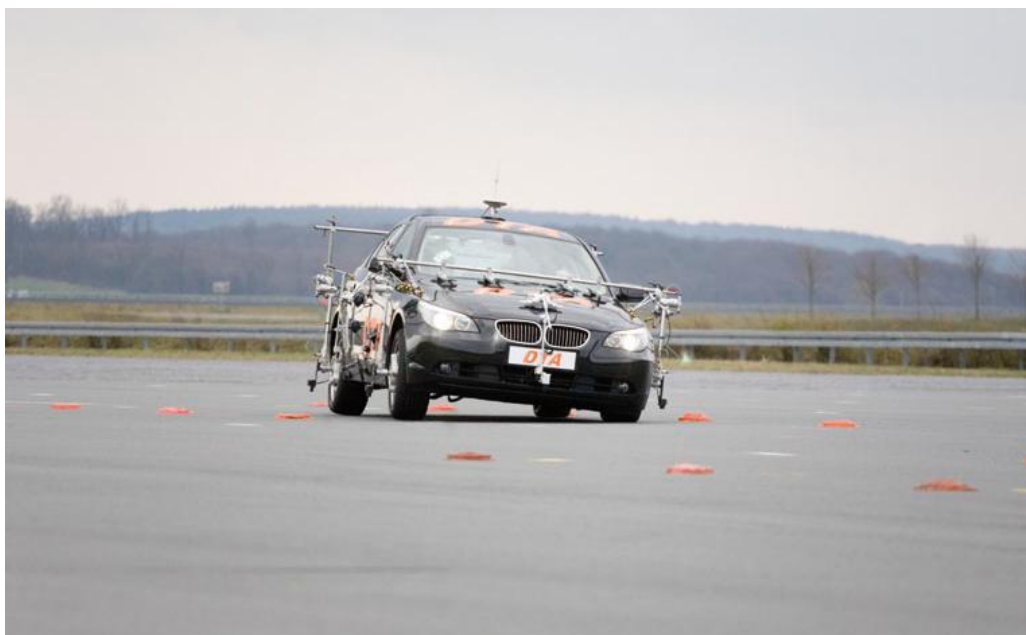
Slika 7. Vozilo opremljeno sensorima i mjernim instrumentima za ispitnu proceduru dvostruke izmjene pravca
