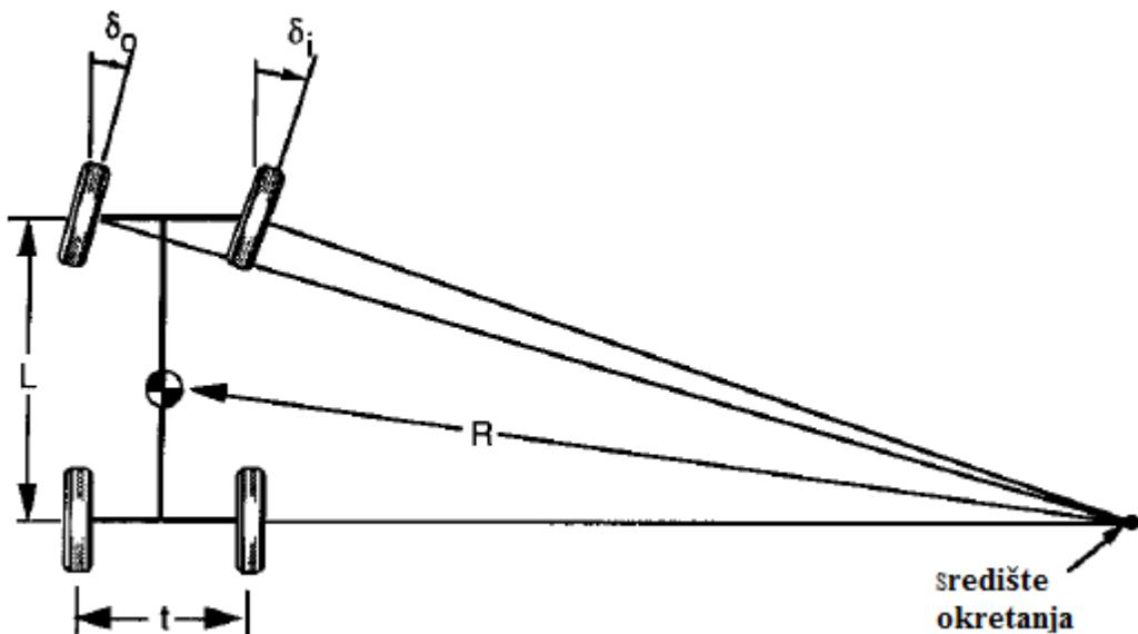
Slika 25. Geometrija vozila prilikom skretanja malom brzinom [7.]
