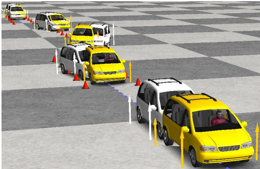
Slika 92. Prikaz animacije vozila s upravljanjem na sve kotače (žuto-4WS, bijelo-standardno vozilo), DLC, 4WS
