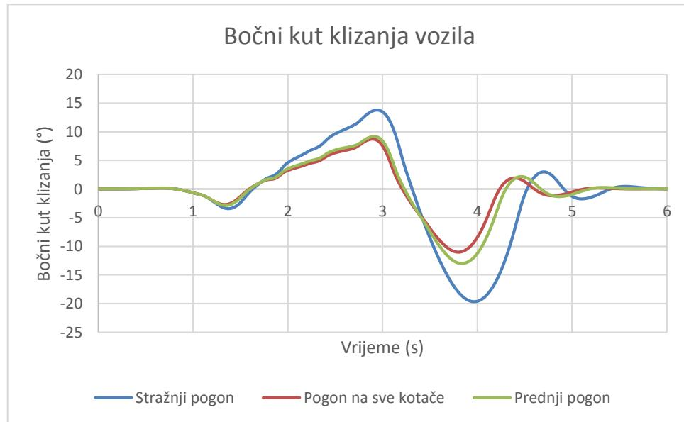
**Slika 93. Bočni kut klizanja vozila, DLC, vrsta pogona**
