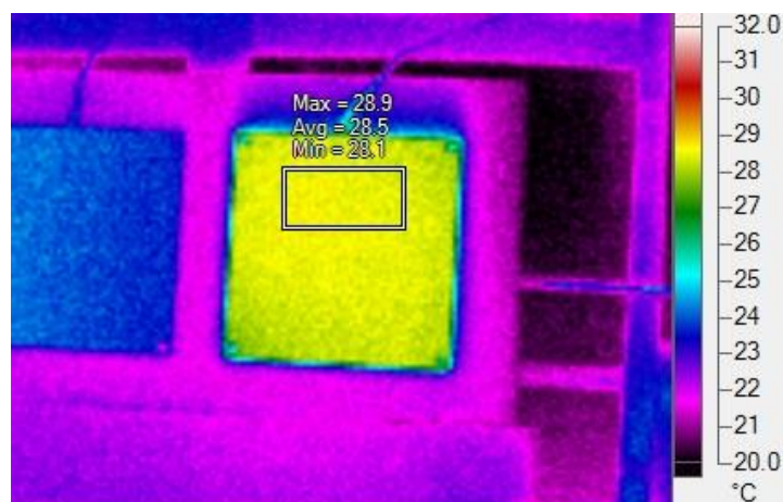
Slika 14. Termogram površine bez visokoreflektivnog premaza (udaljenost reflektora 120 cm)
