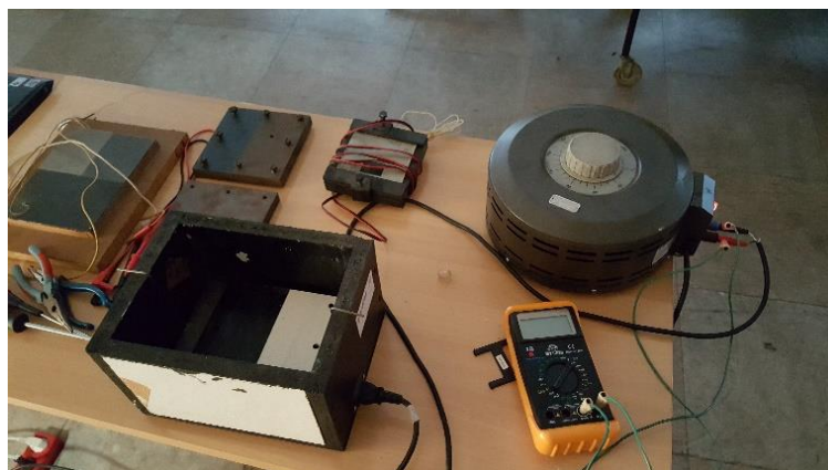
Slika 20. Mjerna linija s električnom grijalicom
