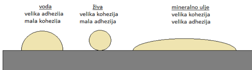
Slika 14. Primjer adhezije i kohezije za različite tvari
