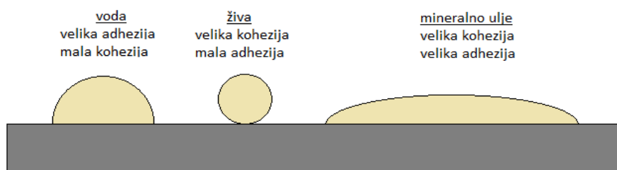
Slika 14. Primjer adhezije i kohezije za različite tvari
