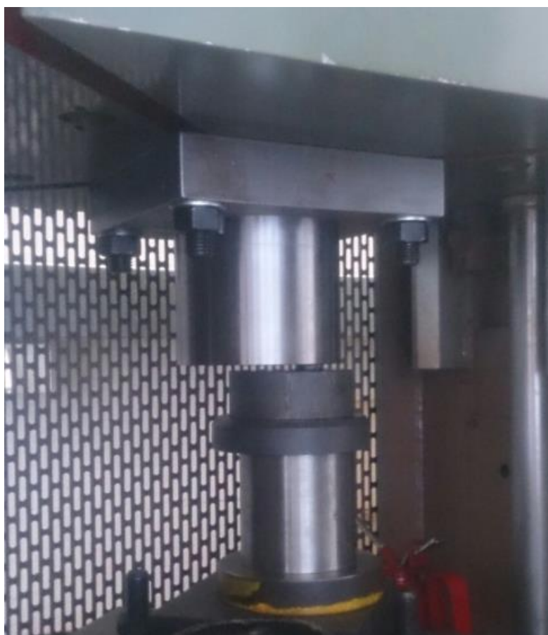
Slika 30. Proces sabijanja ispitnog prstena
