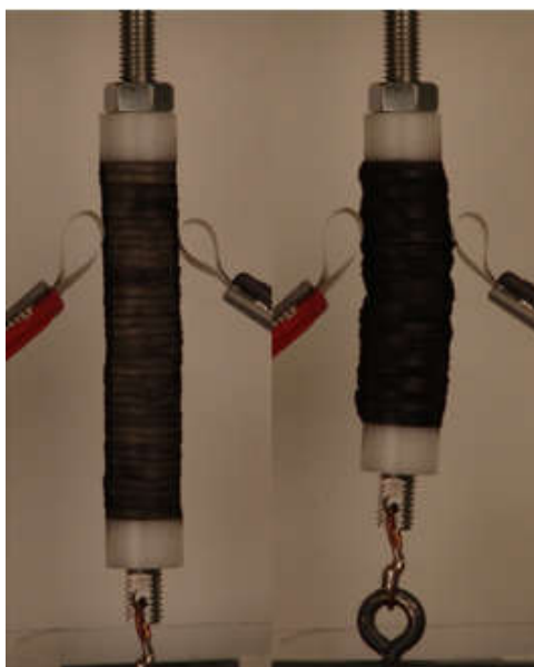
Slika 67. Stog dielektričnih elastomera [46]
