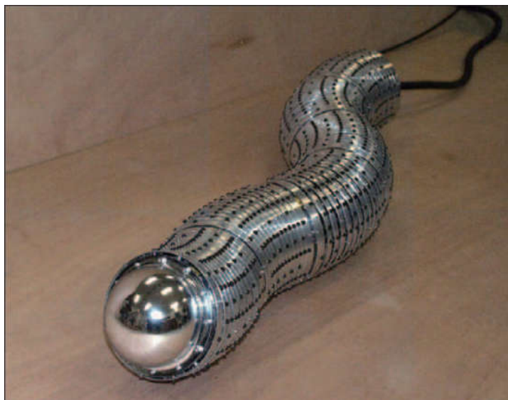
Slika 16. Zmijoliki robot Slim Slime [25]
