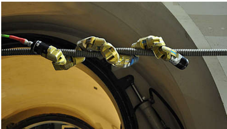
Slika 15. Zmijoliki robot Uncle Sam [31]
