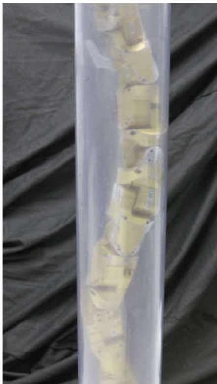
Slika 24. Penjanje robota uz okomitu cijev [15]
