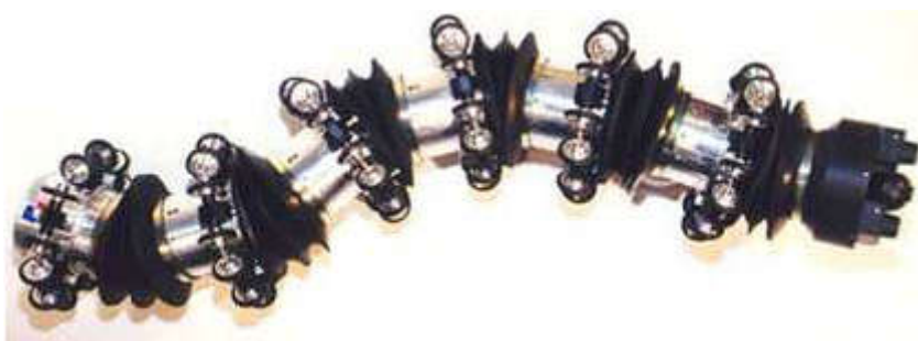
Slika 13. Zmijoliki robot GMD-SNAKE2 [26]
