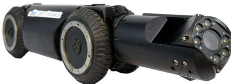
Slika 21. Robot s prednjom kamerom [39]
