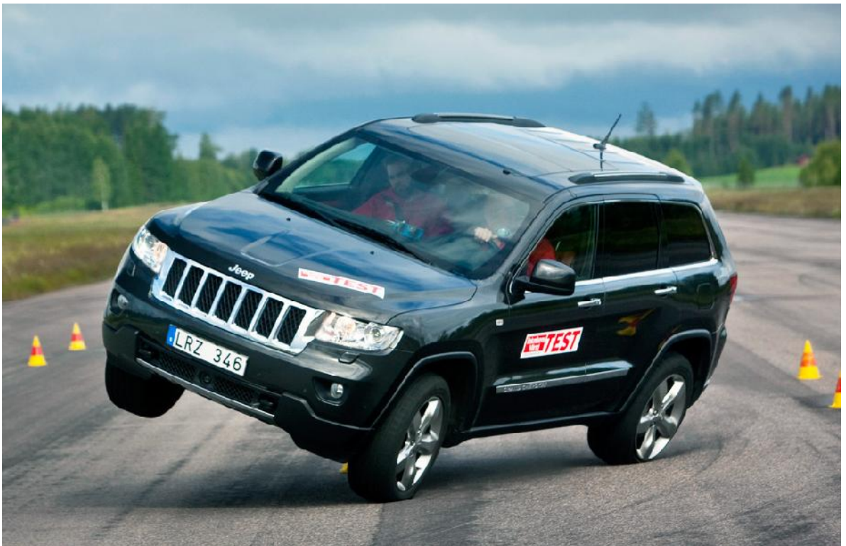
Slika 8. Izvođenje ispitne procedure ISO 3888-2 [10]
