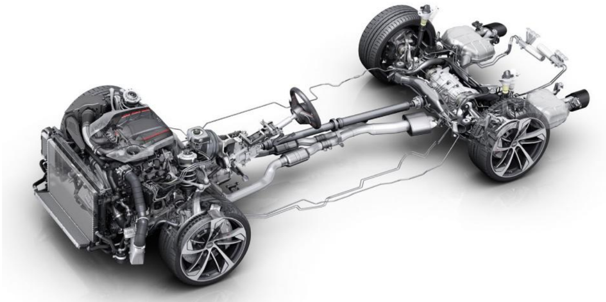
Slika 27. Pogonski sklop Audi-ja RS5 - stalni pogon na sve kota e [33]
