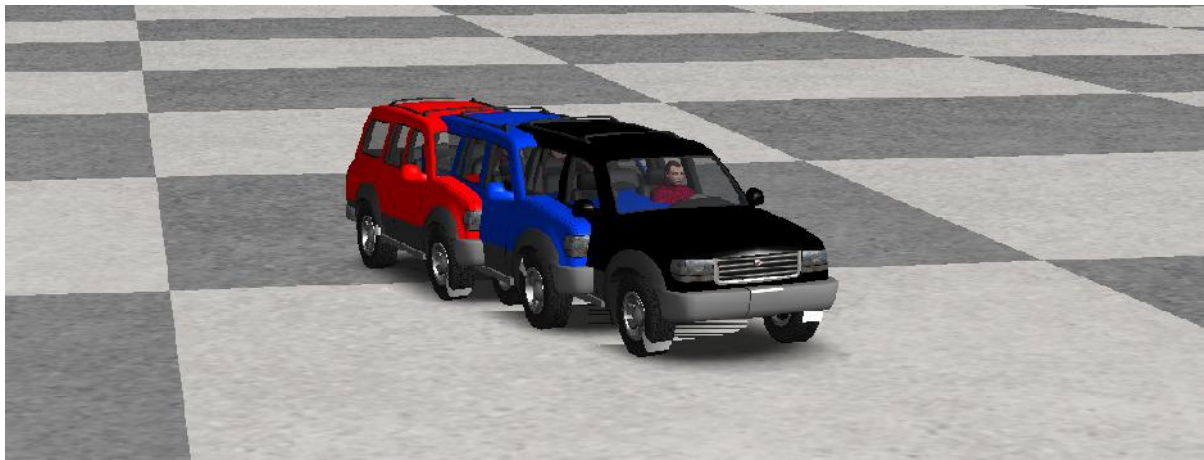
Slika 69. Simulacija ispitne procedure ISO 7401:2011
