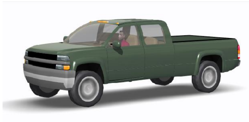
Slika 18. MBS model vozila iz programskog paketa CarSim
