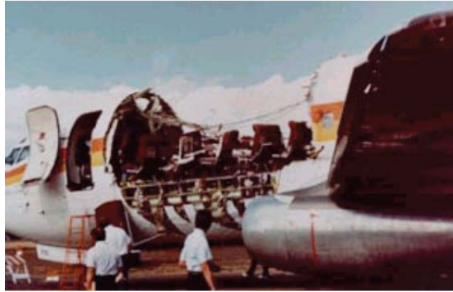
Slika 2.1-9 Oštećenje na Aloha Airlines 737 [6]
