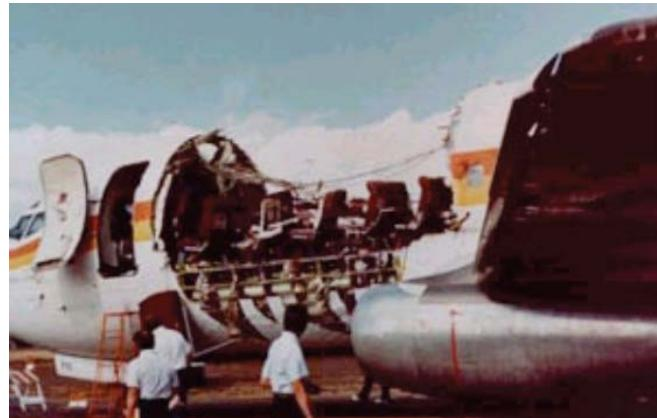
Slika 2.1-9      Oštećenje na Aloha Airlines 737<sup>[6]</sup>
