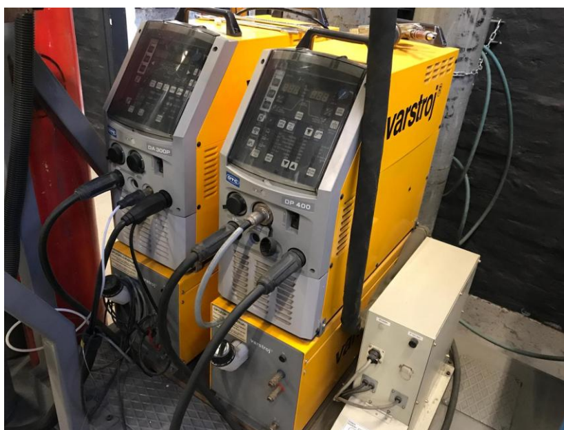
Slika 34. Izvor struje Daihen Varstroj DP400
