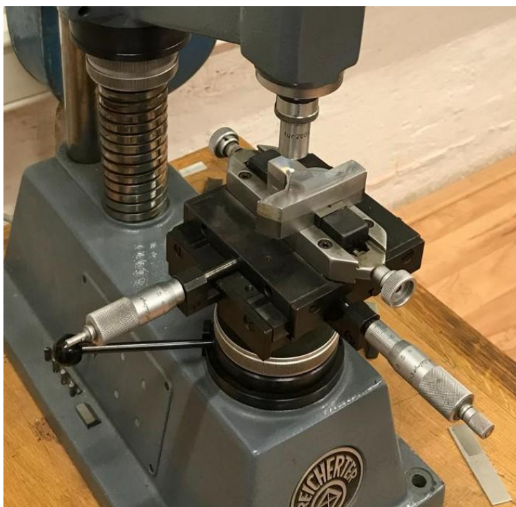
Slika 50. Pozicioniranje točke mjerenja tvrdoće
