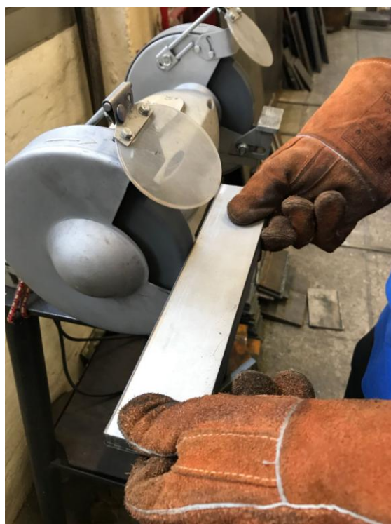
Slika 38. Brušenje površina za zavarivanje
