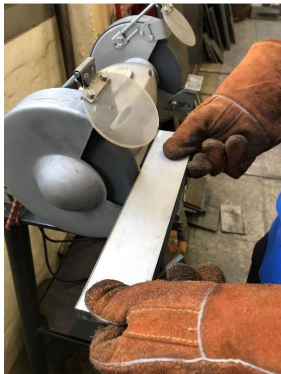
**Slika 38. Brušenje površina za zavarivanje**
