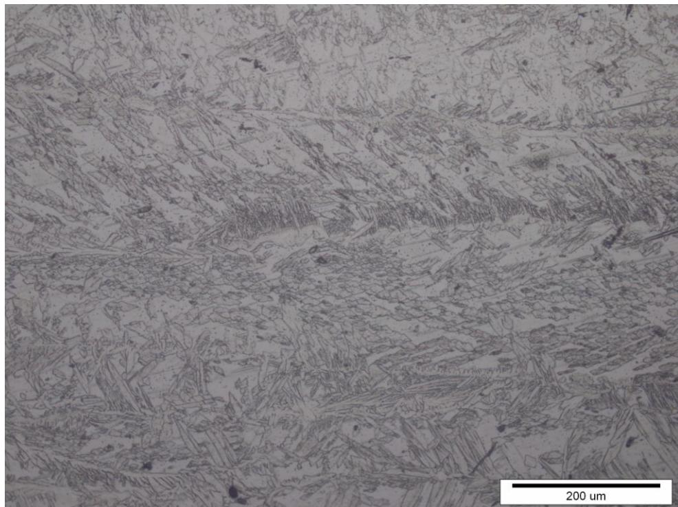
**Slika 60. Mikrostruktura metala zavara na uzorku broj 1, povećanje 200 puta**
