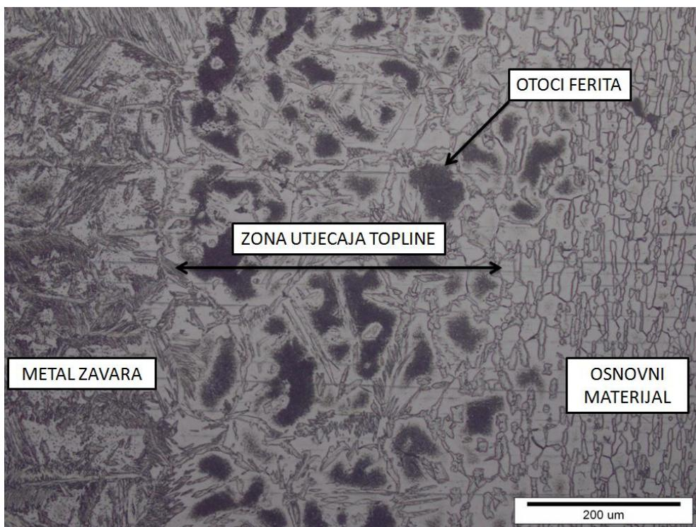
Slika 66. Mikrostruktura ZUT-a uzorka 3, povećanje 200 puta
