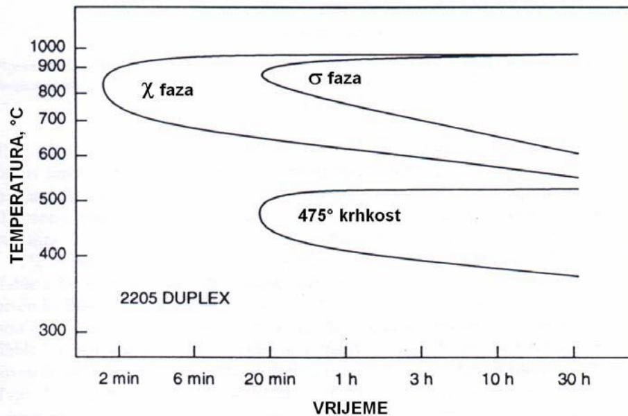
Slika 11. TTT-dijagram nastanka  $\sigma$ - i  $\chi$ -faze za čelik 1.4462 [3]
