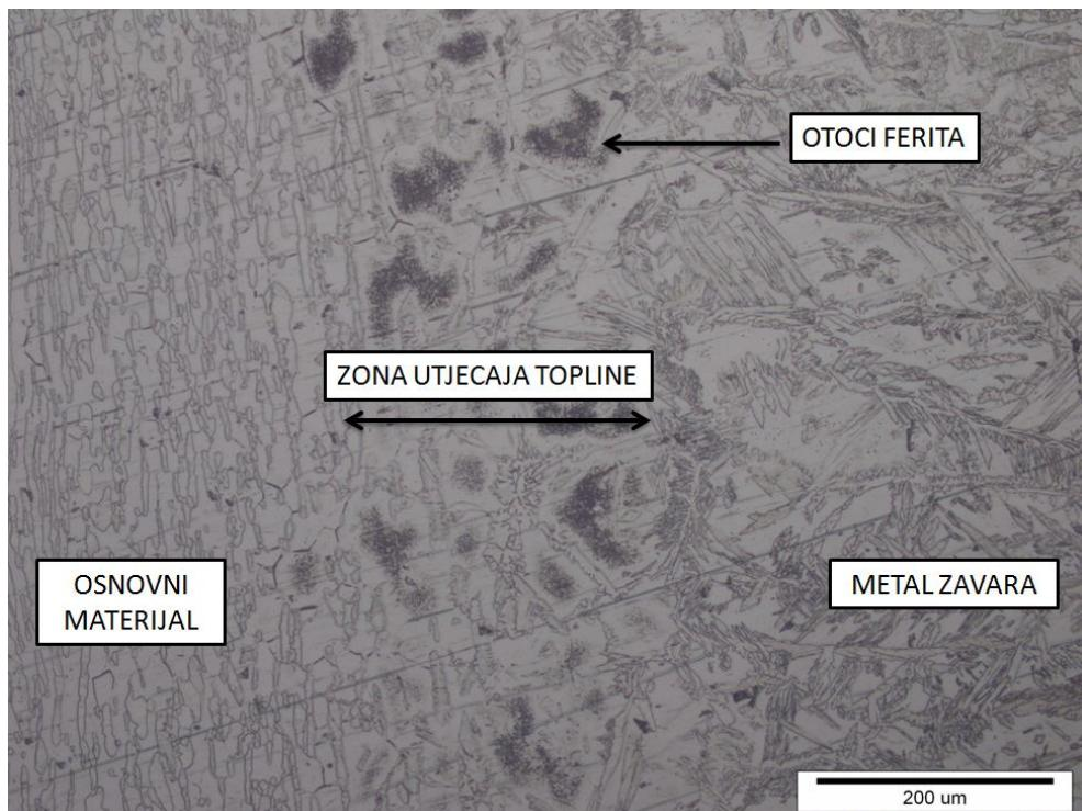
Slika 64. Mikrostruktura ZUT-a uzorka 1, povećanje 200 puta
