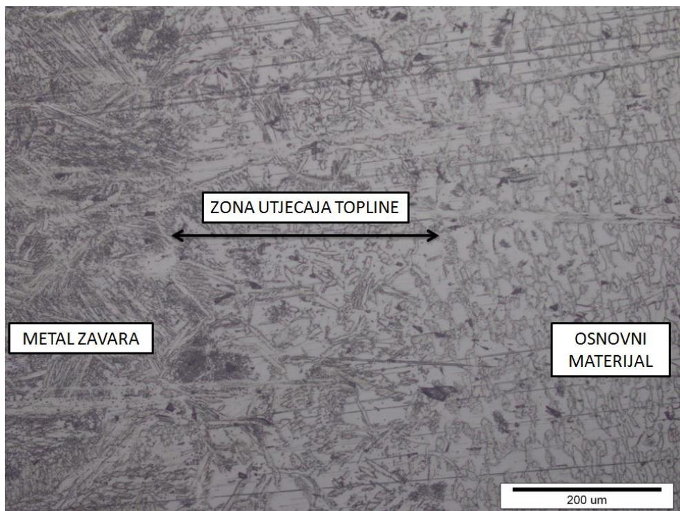
**Slika 67. Mikrostruktura ZUT-a uzorka 4, povećanje 200 puta**
