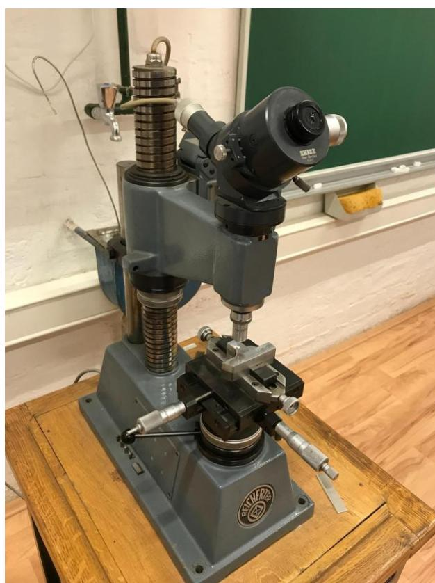
Slika 49. Uređaj za mjerjenje tvrdoće
