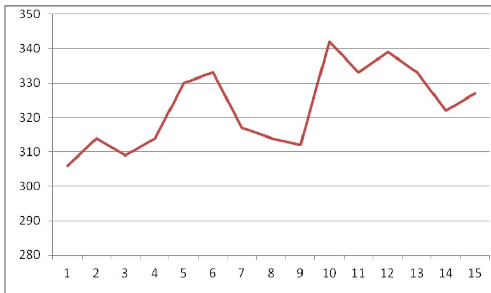
**Slika 58.** Grafički prikaz izmjerene vrijednosti tvrdoće na uzorku broj 4
