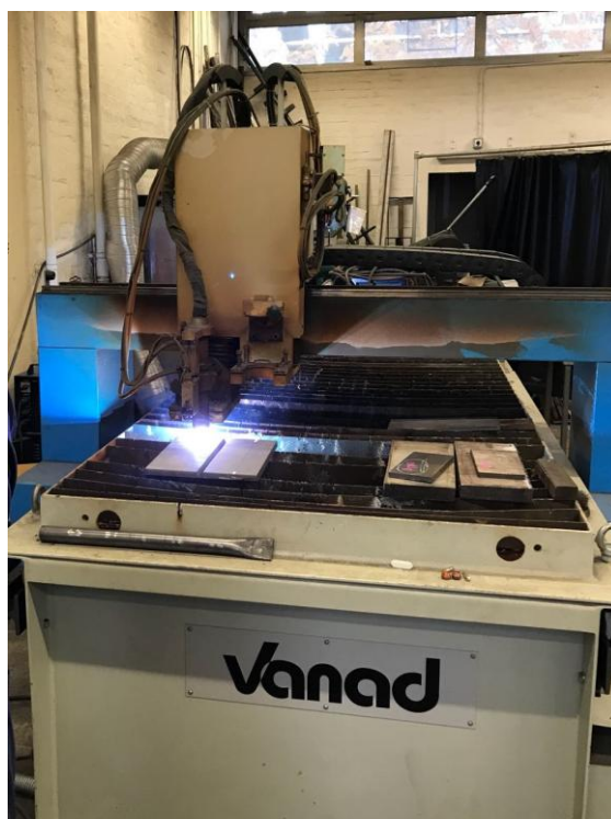
Slika 37. Rezanje uzoraka plazmom
