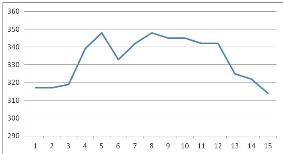
Slika 55. Grafički prikaz izmjerena vrijednosti tvrdoće na uzorku broj 1
