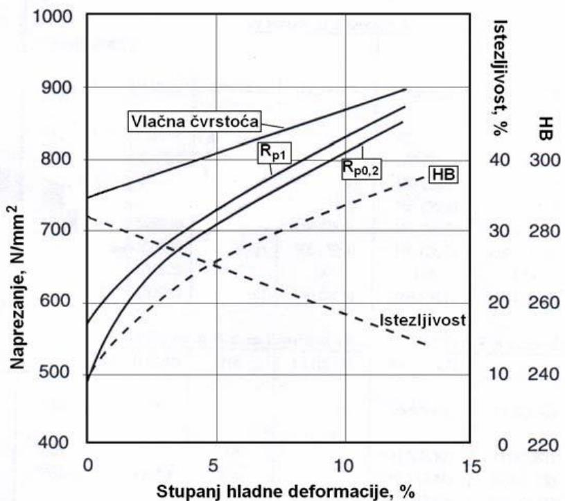
Slika 13. Promjena mehaničkih svojstava čelika 1.4462 [3]
