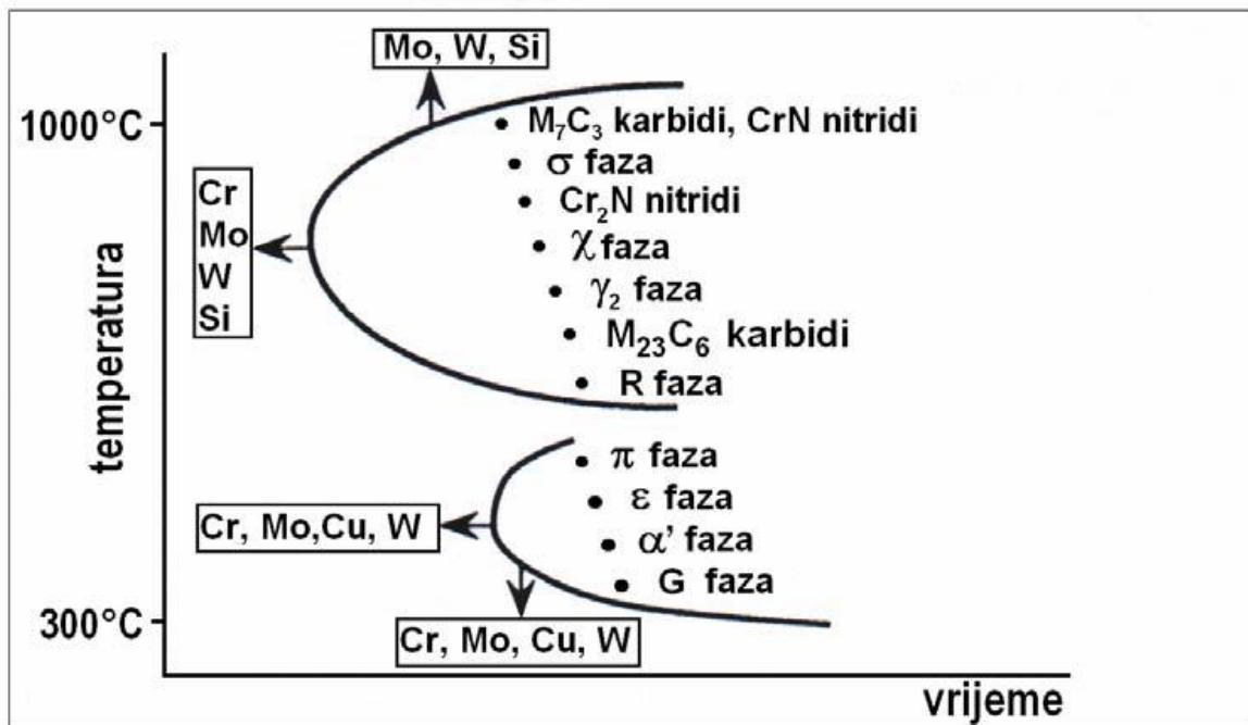
Slika 7. Shematski prikaz tipičnih precipitacija u dupleks čelicima [3]
