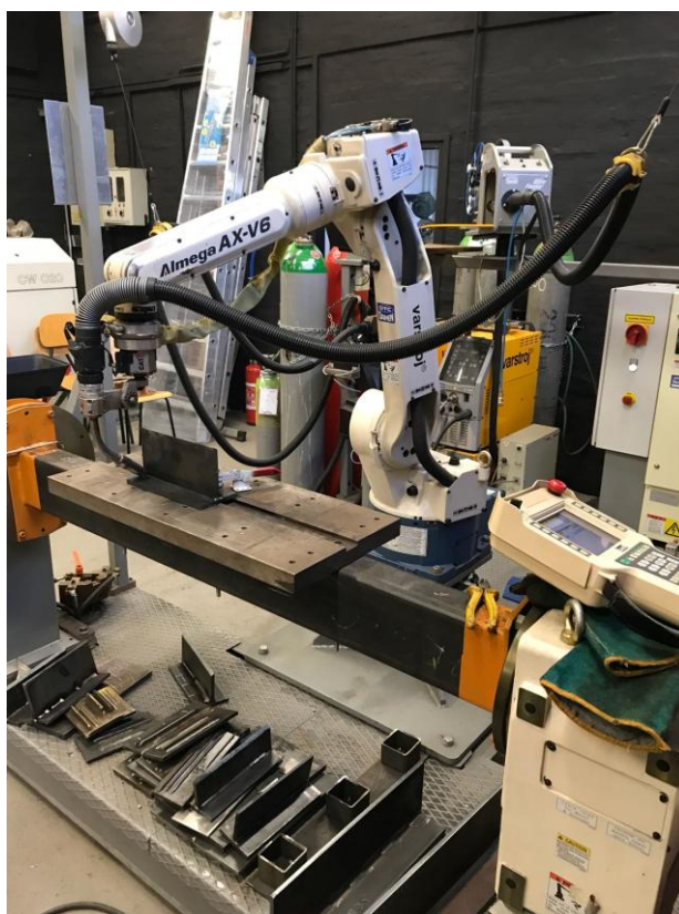
Slika 33. Robot Almega AX-V6
