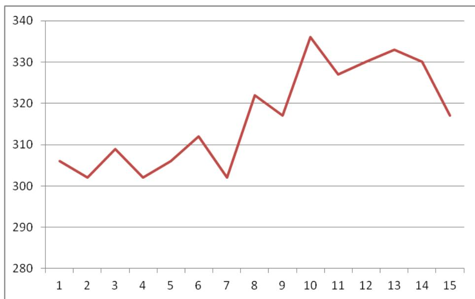
Slika 56. Grafički prikaz izmjerena vrijednosti tvrdoće na uzorku broj 2
