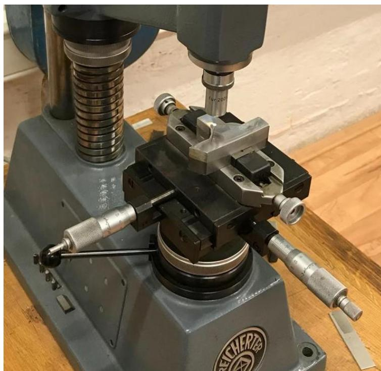
**Slika 50. Pozicioniranje točke mjerena tvrdoće**
