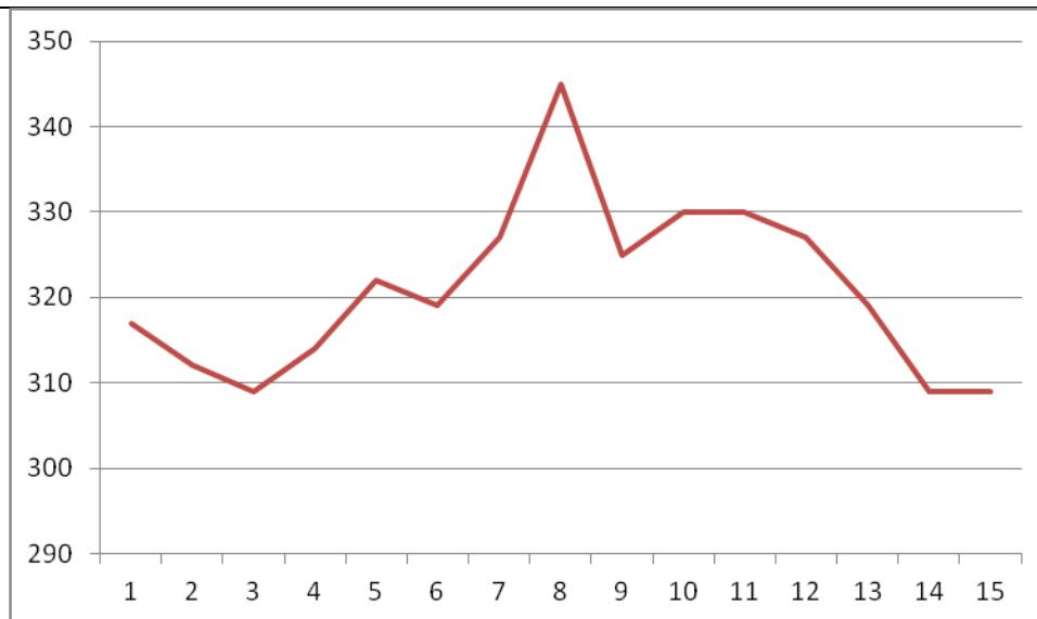
**Slika 57.** Grafički prikaz izmjerene vrijednosti tvrdoće na uzorku broj 3
