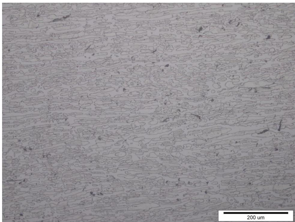
**Slika 59. Mikrostruktura osnovnog materijala, povećanje 200 puta**
