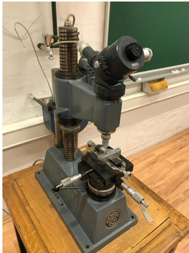
Slika 49. Uređaj za mjerenje tvrdoće
