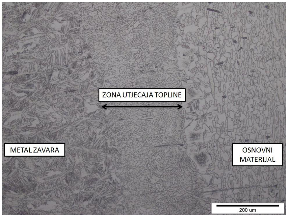
Slika 65. Mikrostruktura ZUT-a uzorka 2, povećanje 200 puta
