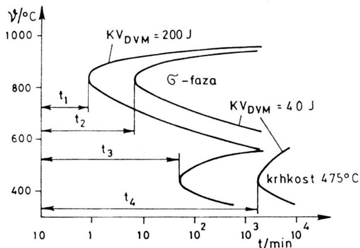
Slika 18. Izotermički dijagram izlučivanja u čeliku X2CrNiMoN 25 5 3 [7]
