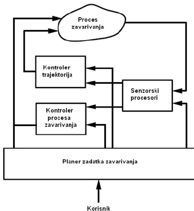
**Slika 27. Modularna arhitektura adaptivnog upravljanja robotiziranim procesom zavarivanja [18]**
