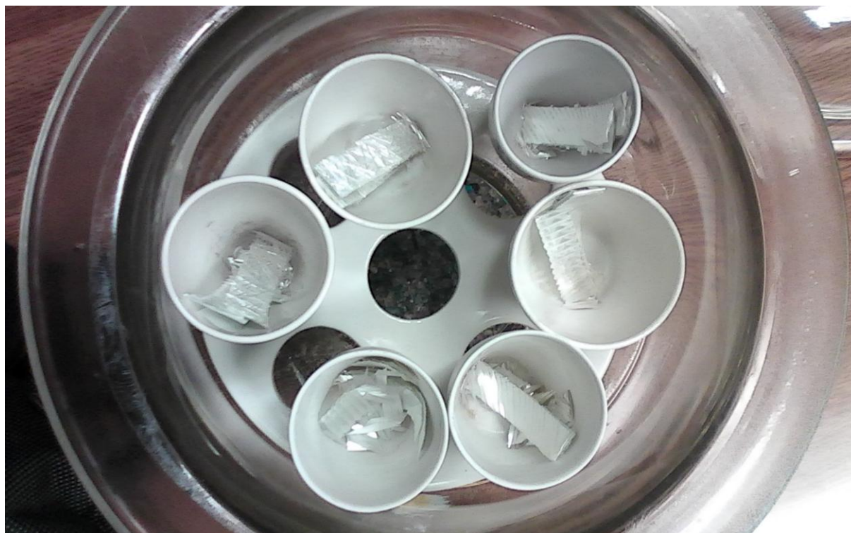
Slika 6.18. Ispitna tijela nakon postupka žarenja
