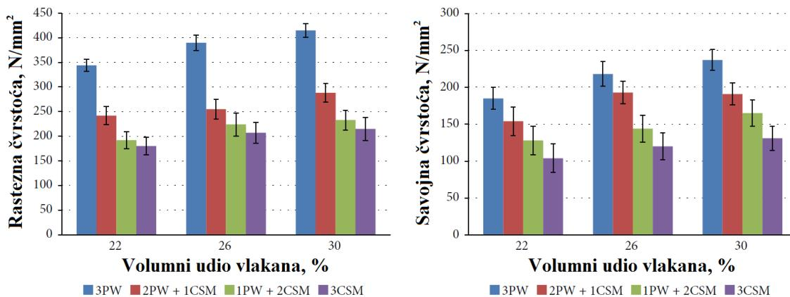
Slika 4.21. Rezultati: a) rastezne i b) savojne čvrstoće [21]
