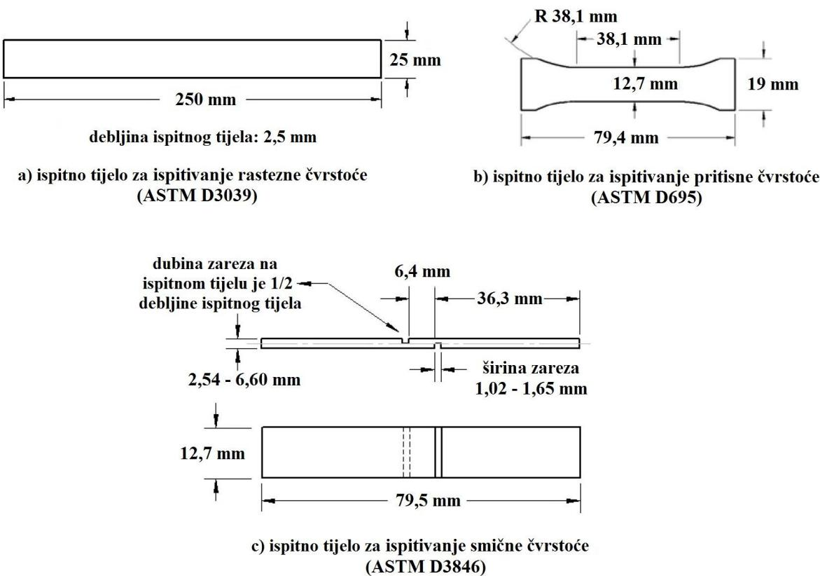
Slika 4.14. Dimenzije ispitnih tijela za ispitivanje mehaničkih svojstava [20]
