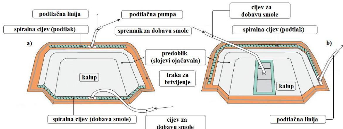
Slika 4.6. Pozicija spiralne cijevi u kalupu: a) jedna nasuprot drugoj, b) uz rub kalupa [11]
