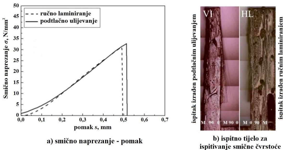
**Slika 4.16. Prikaz a) dijagrama smičnog naprezanja, b) ispitak VI i HL nakon ispitivanja [20]**
