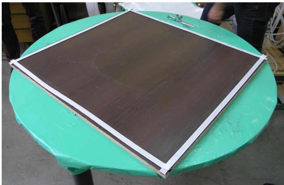
Slika 6.2. Kalup s trakom za brtvljenje folije
