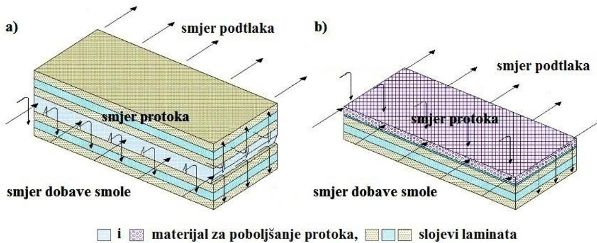
**Slika 4.5. Materijal za poboljšavanje protoka: a) između laminata, b) na sloju *peel-ply-a* [19]**
