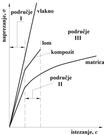
Slika 3.5. Dijagram naprezanje – istezanje vlaknima ojačanog kompozita [4]
