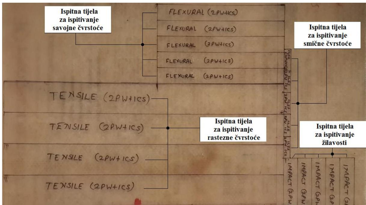
Slika 4.20. Kompozitna ploča s iscrtanim uzorcima za ispitivanje [21]
