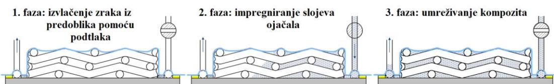
Slika 4.1. Postupak podtlaćnog ulijevanja (VIP) [19]
