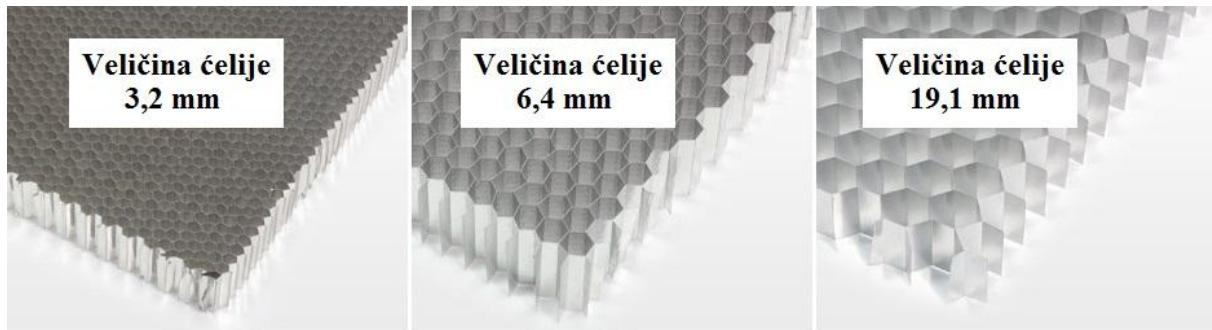
Slika 3.15. Aluminijске sače debljine  $h = 10 \text{ mm}$  [16]
