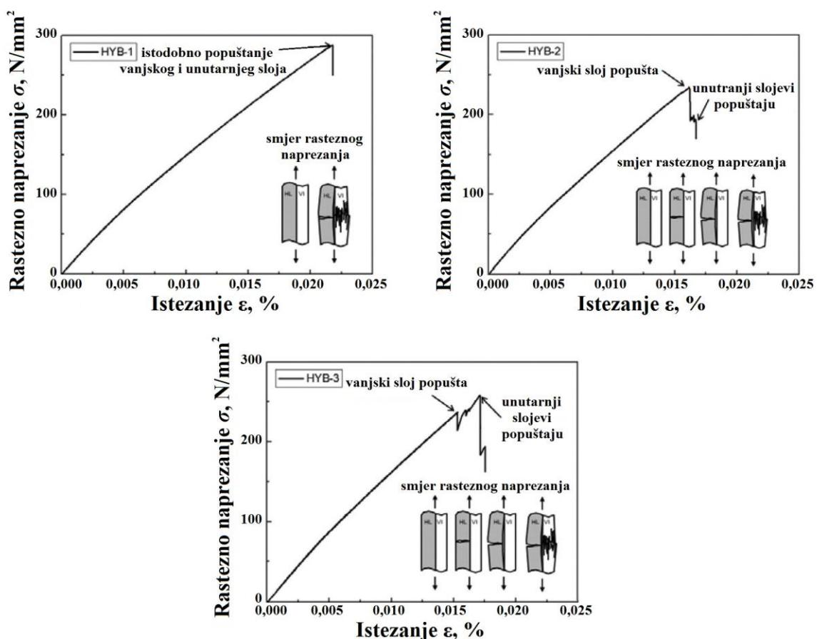
Slika 4.17. Dijagram rastezno naprezanje – istezanje [20]
