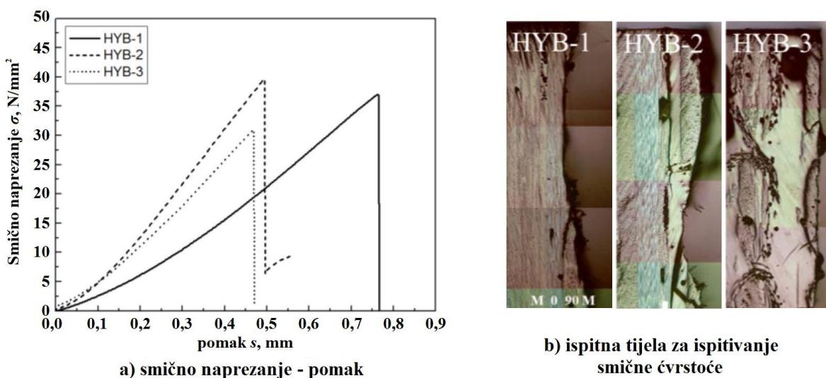
Slika 4.19. Prikaz a) dijagrama smičnog naprezanja, b) ispitak HYB nakon ispitivanja [20]
