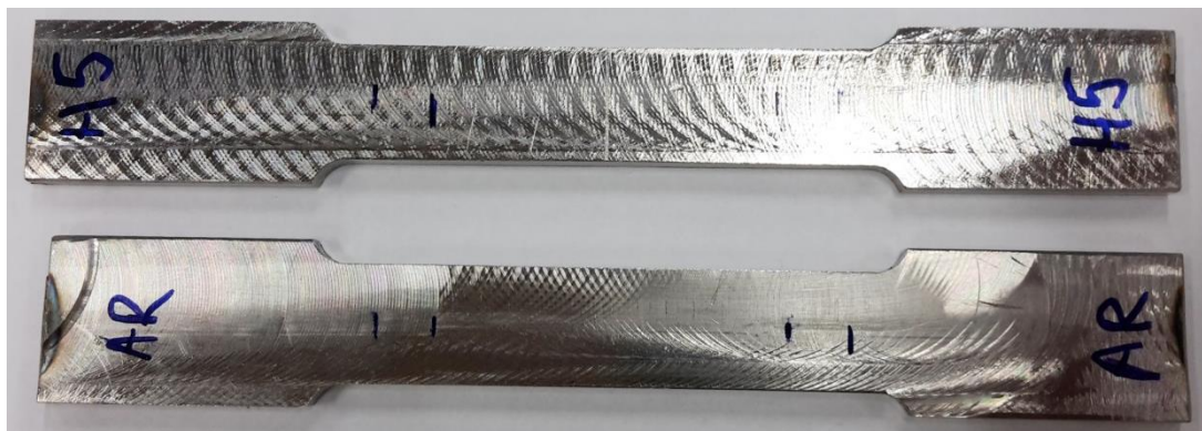
Slika 54. Epruveta za statički vlačni pokus
