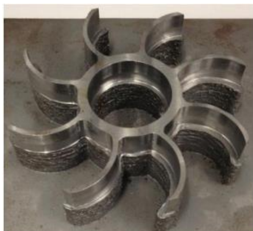
Slika 15. Rotor izrađen WAAM postupkom [11]
