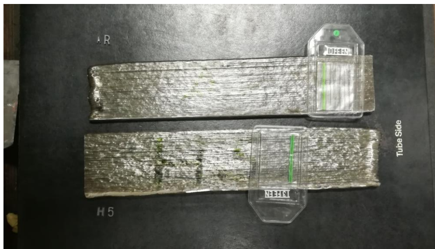
Slika 55. Uzorci prije radiografskog snimanja
