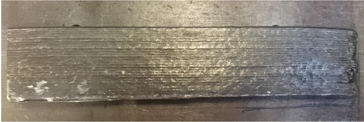
Slika 52. Zid odrezan od podloge
