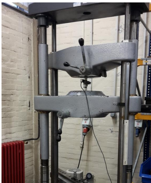
Slika 66. Kidalica i uzorak tijekom ispitivanja
