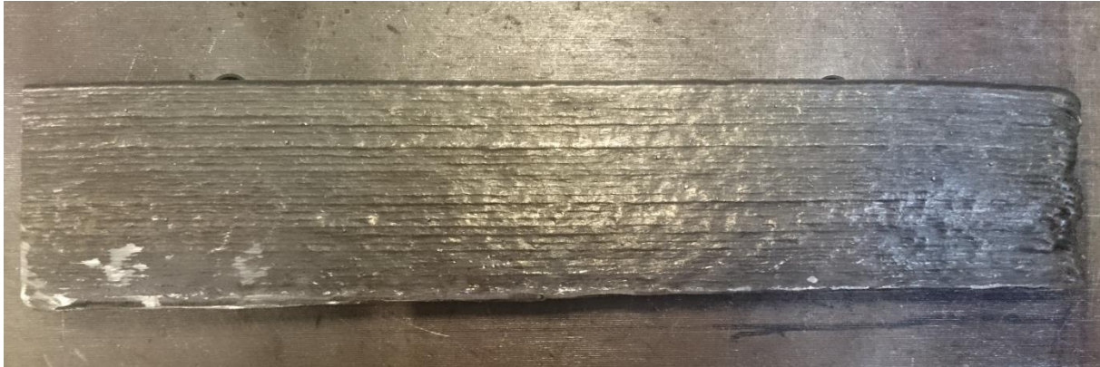
Slika 52. Zid odrezan od podloge
