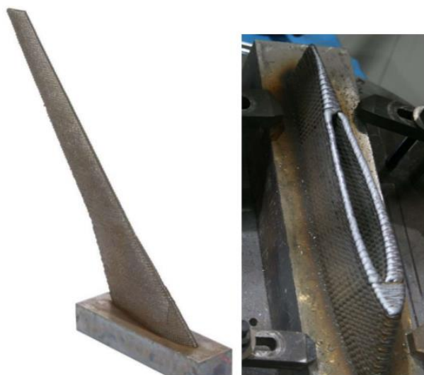
Slika 16. Model krila izrađen WAAM postupkom [13]
