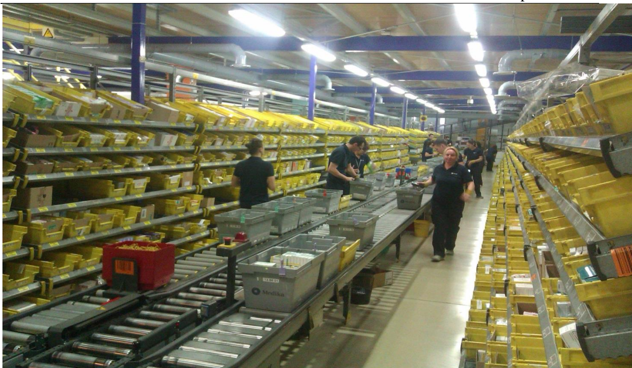
Slika 4.8. Komisioniranje u zoni „WMS-a“ – pokretna traka
