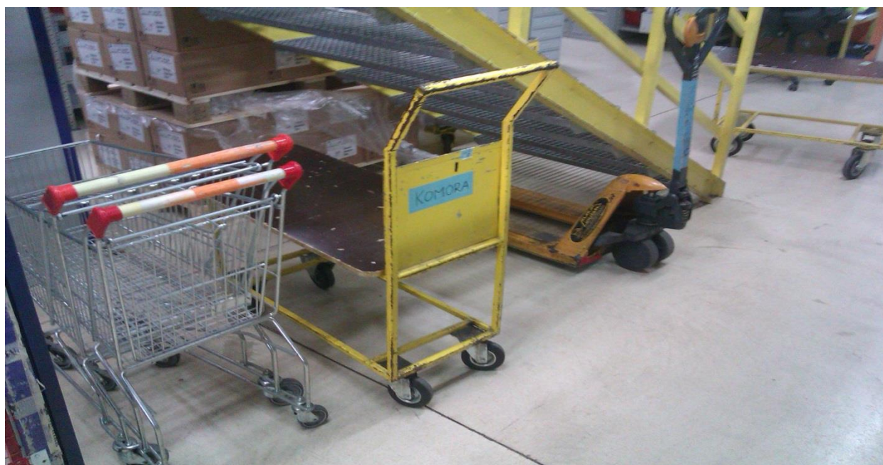
Slika 3.18. Različite izvedbe kolica i ručni viličar
