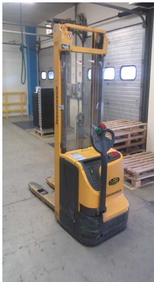
Slika 3.16. Električni visokopodizni viličar
