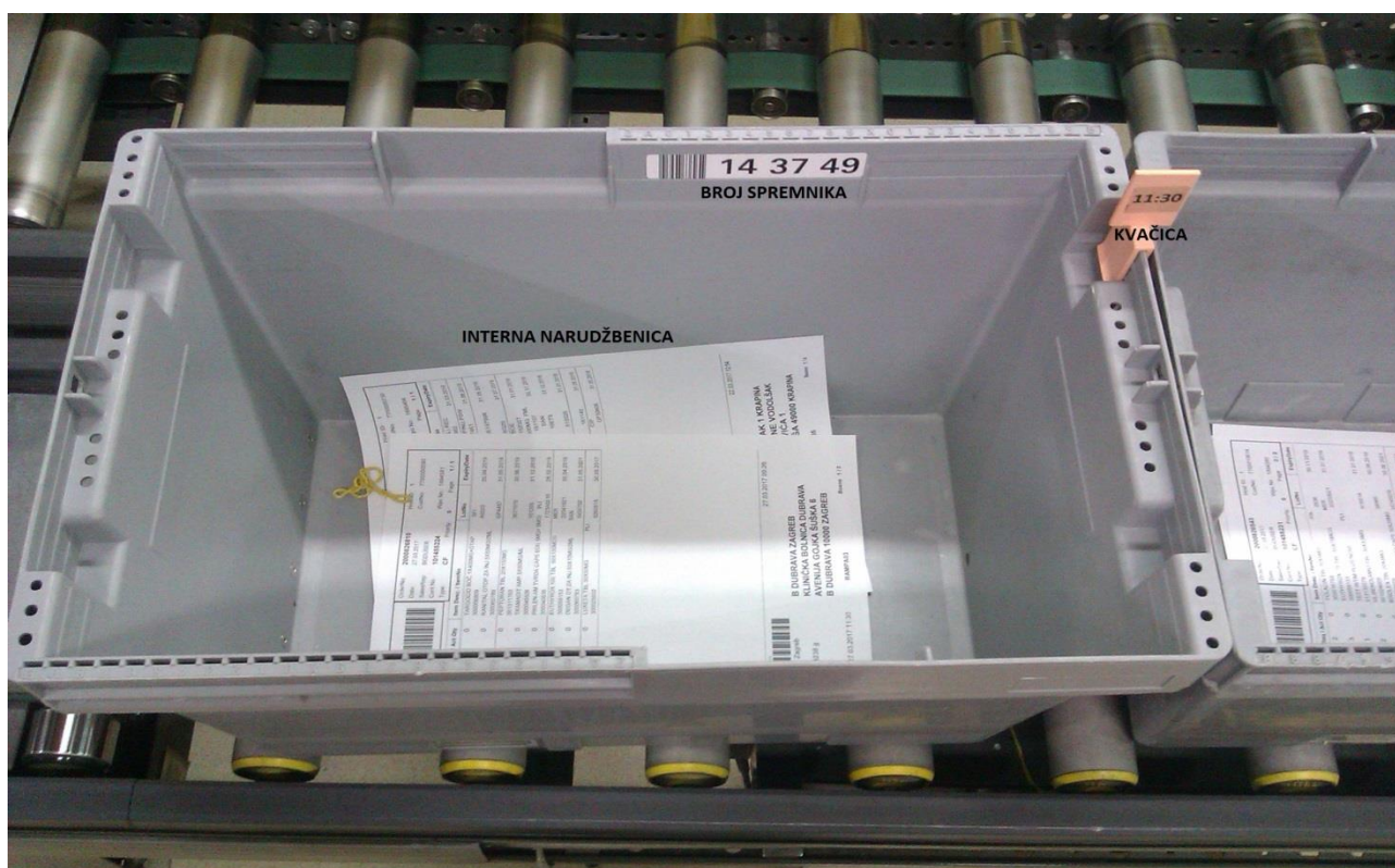
Slika 4.7. Sivi spremnici – „WMS“ komisioniranje, pokretna traka
