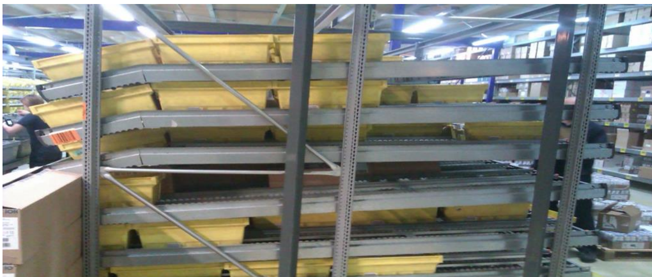
Slika 3.24. Protočni regal – Skladišna zona „WMS“
