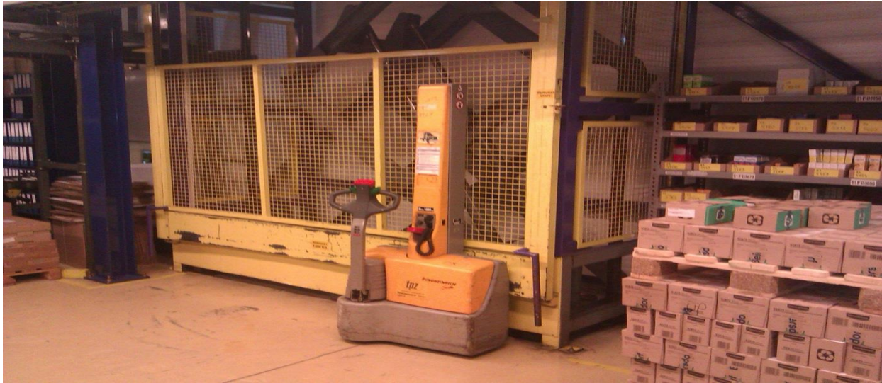
Slika 3.20. Hidraulična škarasta platforma
