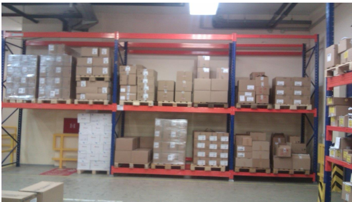
Slika 3.22. Jednostruki paletni regali - zona za razvrstavanje
