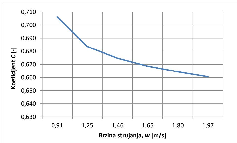
Dijagram 4. Odnos koeficijenta  $C$  i brzine strujanja - ventilator
