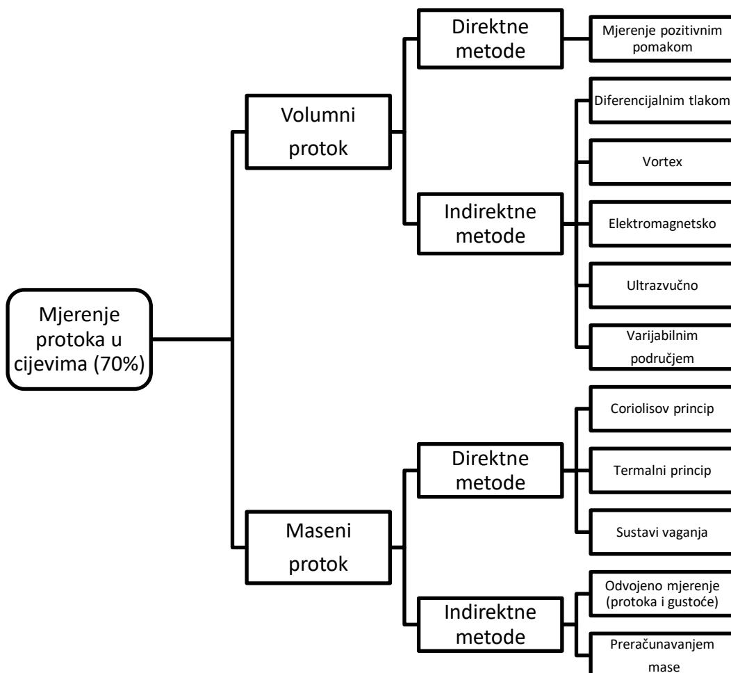
**Dijagram 1.** Podjela metoda mjerjenja protoka u cijevima
