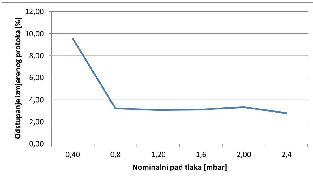
**Dijagram 6.** Odnos odstupanja izmjerenoj protok u odnosu na izračunati maseni protok u slučaju ventilatora
