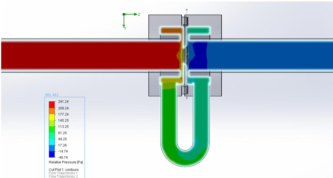
Slika 10. Vrijednosti relativnog tlaka unutar mjerne linije
