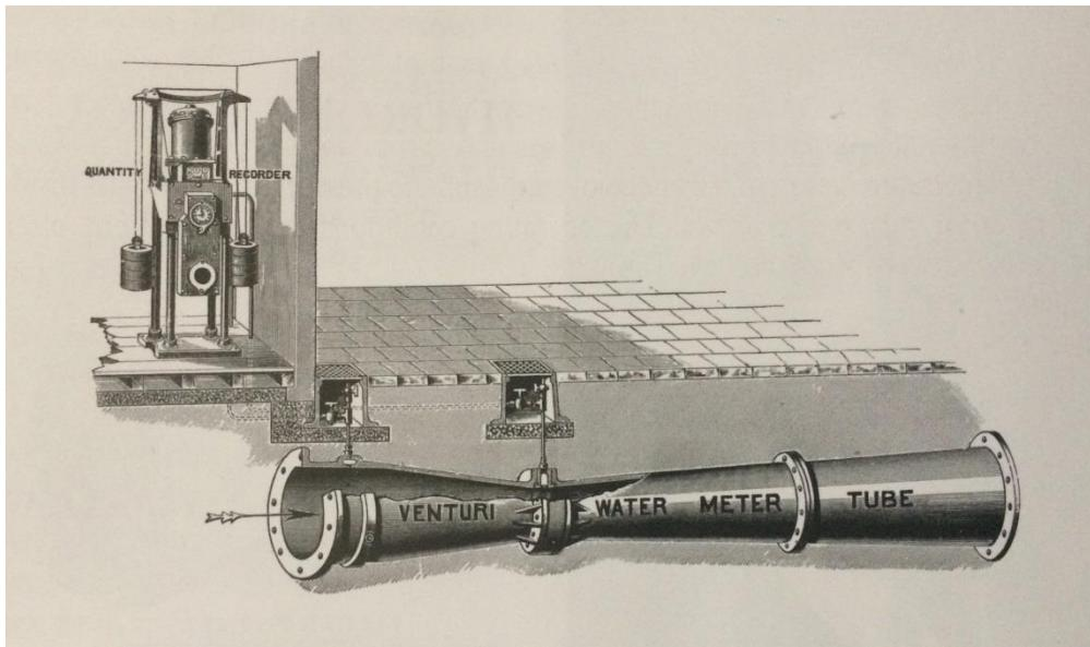
**Slika 1.** Venturijeva cijev za mjerjenje protoka u vodovodu, 19. Stoljeće
