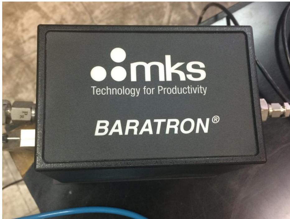
Slika 14. Pretvornik tlaka Baratron 120A
