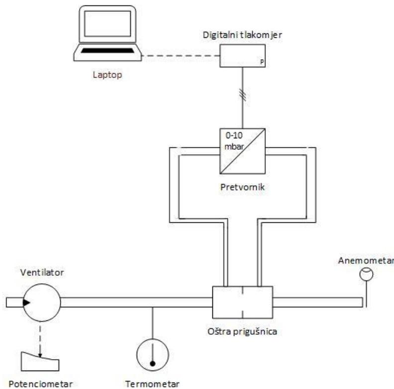
Slika 7. Shematski prikaz mjerne linije
