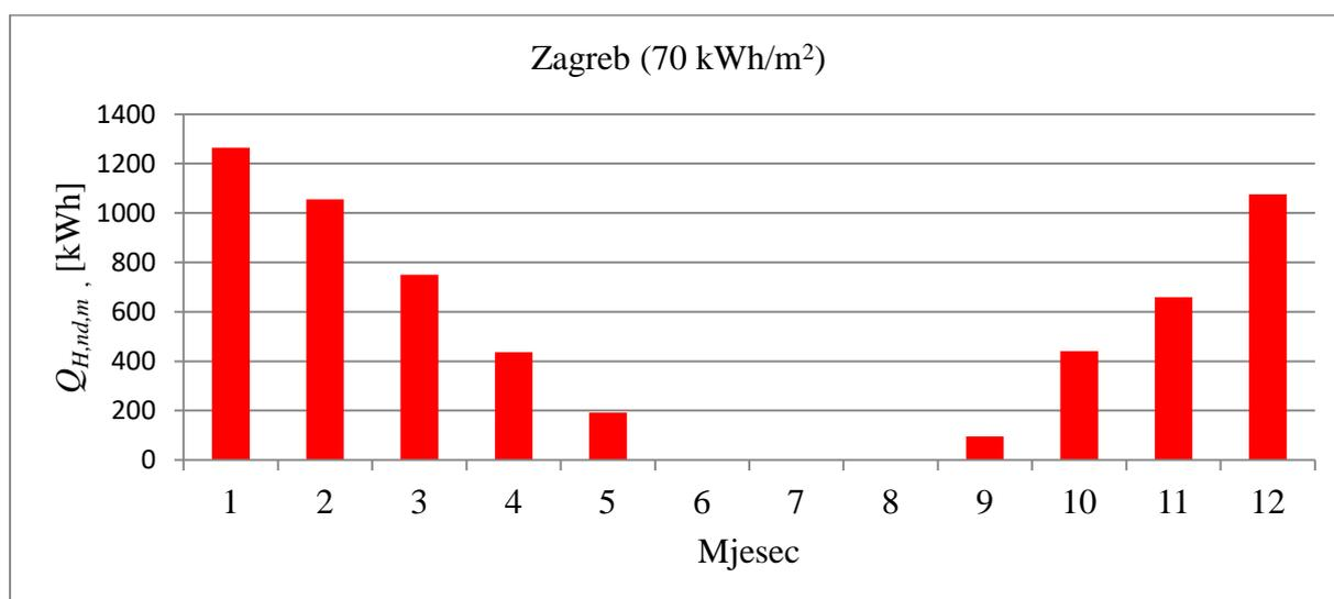
Slika 2. Mjesečna raspodjela potrebne toplinske energije za grijanje (Zagreb, 70 kWh/m<sup>2</sup>)
