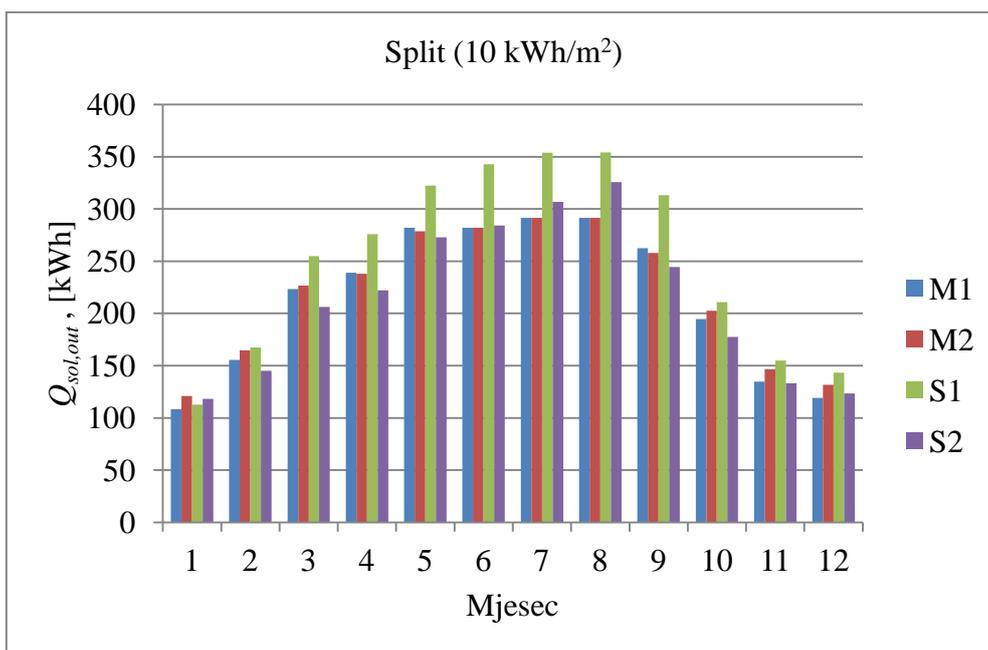
Slika 11. Rezultati - isporučena Sunčeva energija u sustav (Split, 10 kWh/m<sup>2</sup>)
