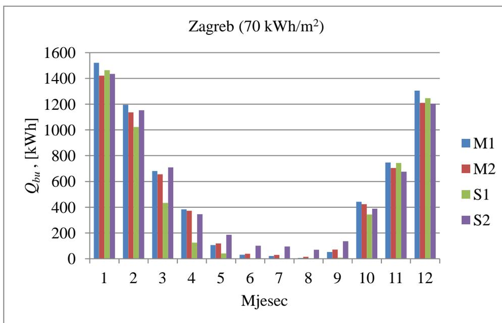
Slika 20. Toplinska energija koju je potrebno isporučiti dodatnim generatorom topline (Zagreb, 70 kWh/m<sup>2</sup>)
