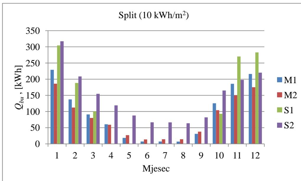
Slika 23. Toplinska energija koju je potrebno isporučiti dodatnim generatorom topline (Split, 10 kWh/m<sup>2</sup>)
