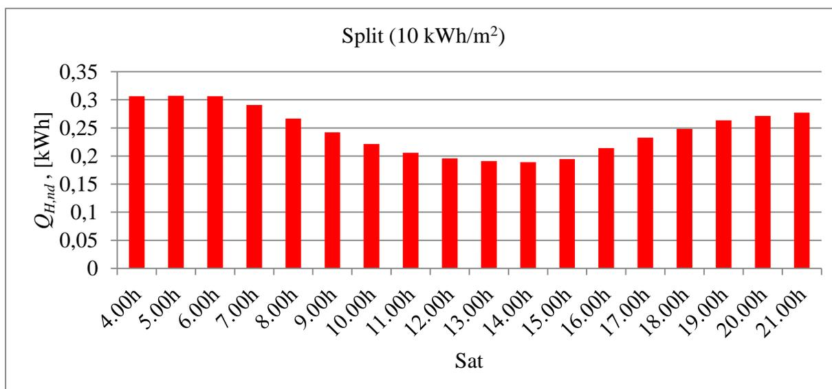
**Slika 5. Satna raspodjela potrebne toplinske energije za grijanje za karakterističan dan u ožujku (Split, 10 kWh/m<sup>2</sup>)**
