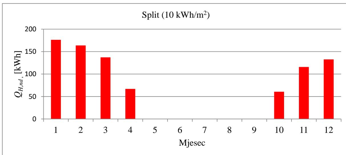
Slika 3. Mjesečna raspodjela potrebne toplinske energije za grijanje (Split, 10 kWh/m<sup>2</sup>)
