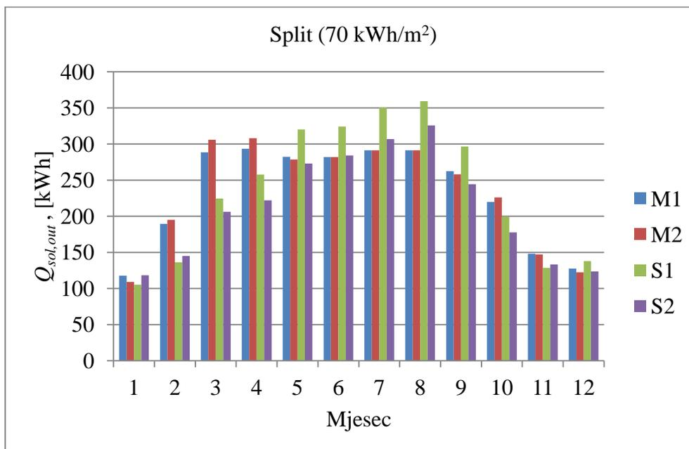
Slika 10. Rezultati - isporučena Sunčeva energija u sustav (Split, 70 kWh/m<sup>2</sup>)
