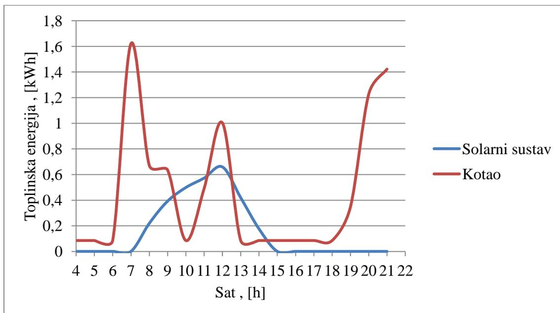
**Slika 17. Podrška solarnog sustava i kotla na biomasu (proračun S2, karakterističan dan u veljači)**
