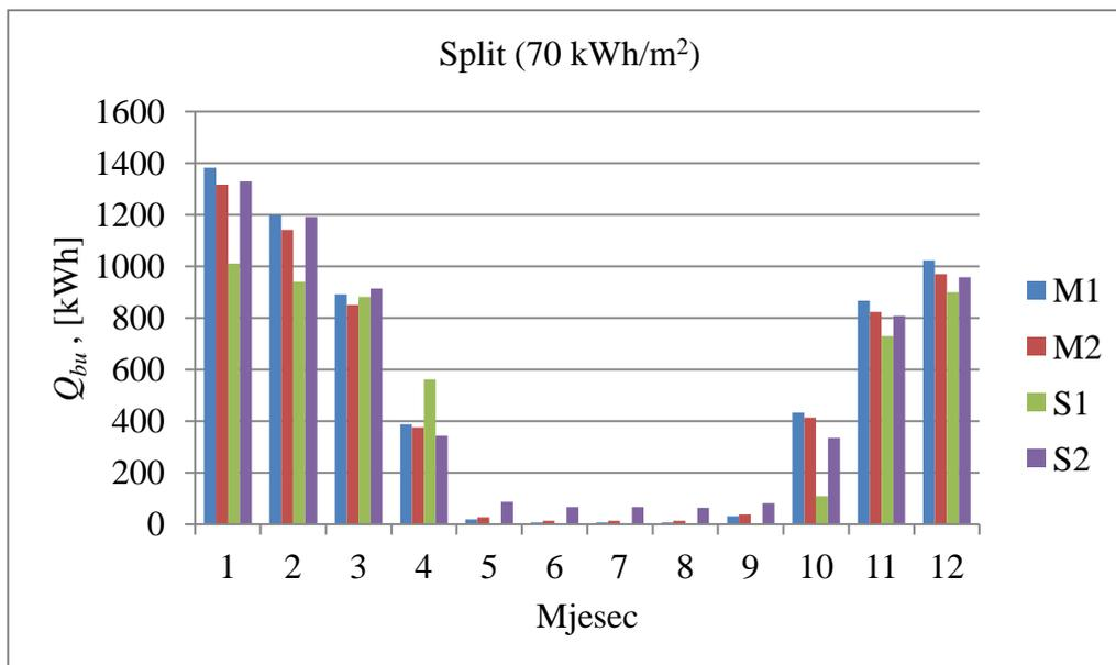
Slika 22. Toplinska energija koju je potrebno isporučiti dodatnim generatorom topline (Split, 70 kWh/m<sup>2</sup>)
