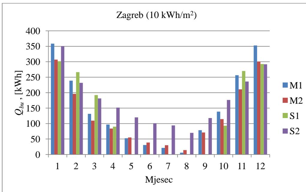
Slika 21. Toplinska energija koju je potrebno isporučiti dodatnim generatorom topline (Zagreb, 10 kWh/m<sup>2</sup>)
