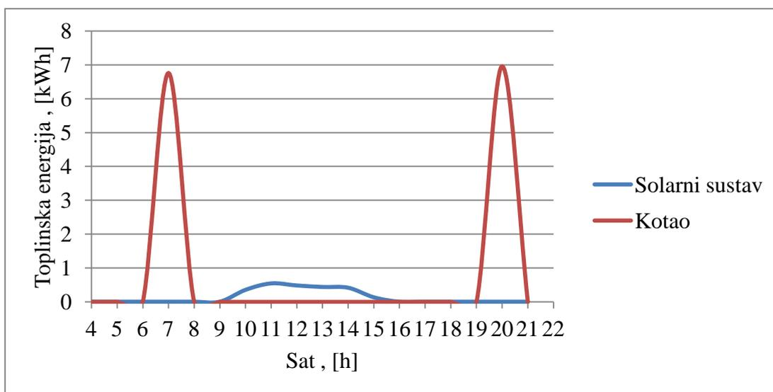
**Slika 13. Podrška solarnog sustava i kotla na biomasu - (proračun S1, karakterističan dan u veljači)**
